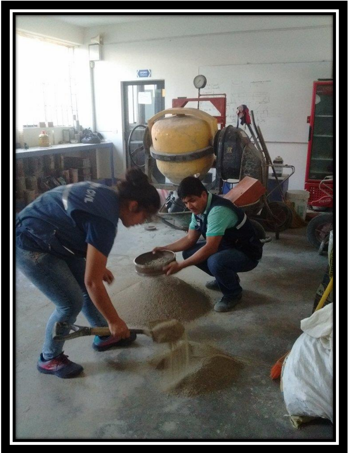
Figura N o 4: Realizando los ensayos de calidad de los agregados y su gradación
