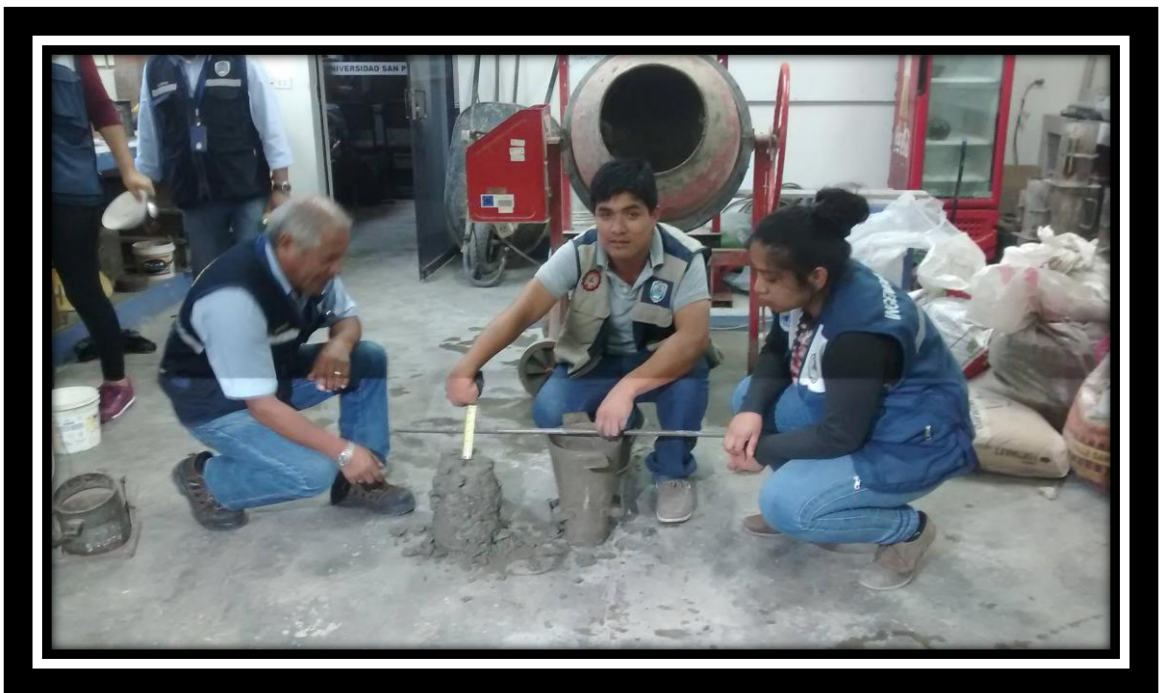
Figura N°7: Midiendo la trabajabilidad del concreto
