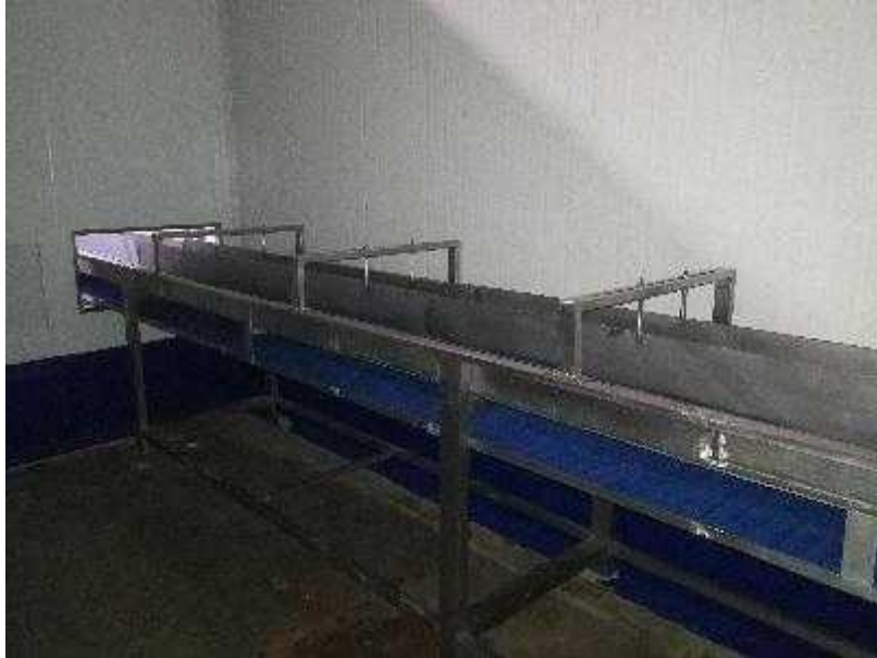
Figura 50. Zona de Faja Transportadora de Pota Seccionada para su Envasado. Fuente (Aguilar, 2016)
