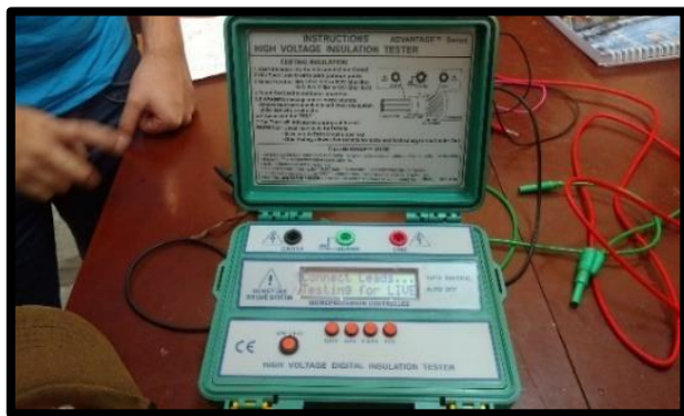
Foto 9.- Megóhmetro de 10 kV.
