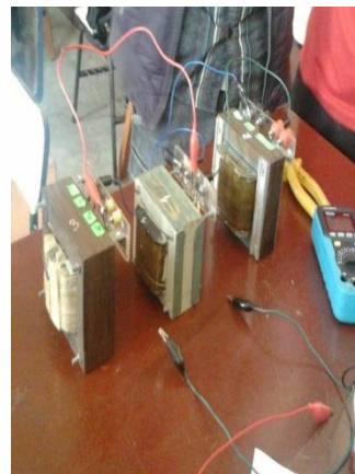
Foto 17.- Bancada de transformadores
