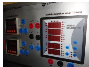
Foto 13.- Medidor multifuncional trifásico
