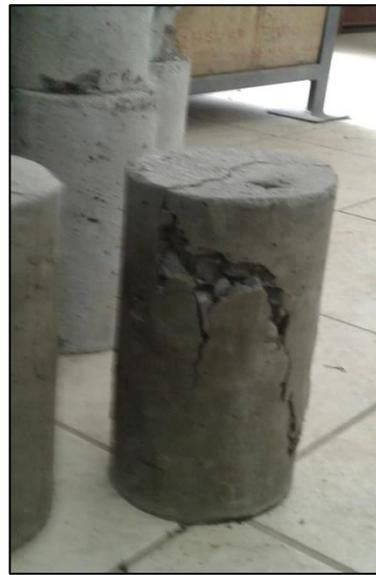
Rotura de probetas a los 7, 14 y 28 días de curado.
