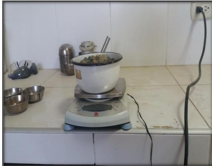
Ensayo de contenidos de humedad y pesos unitarios de los agregados.
