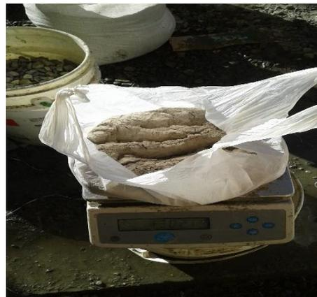
Pesando los materiales para la elaboración de la mezcla  $f_c = 210 \text{ kg/cm}^2$
