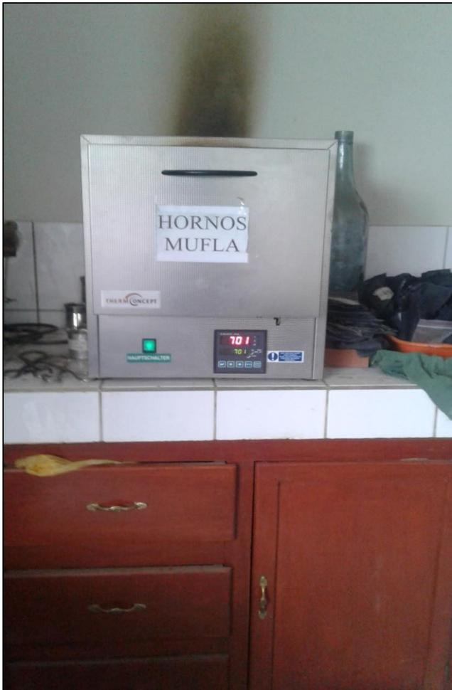
Calcinación de la ceniza de eucalipto en el horno mufla de la UNASAM.
