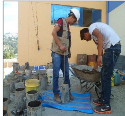
Realizando la prueba del cono de abrams
