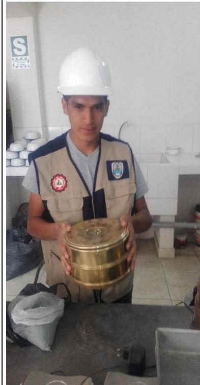
Cuarteo y tamizado de los agregados para el análisis granulométrico.
