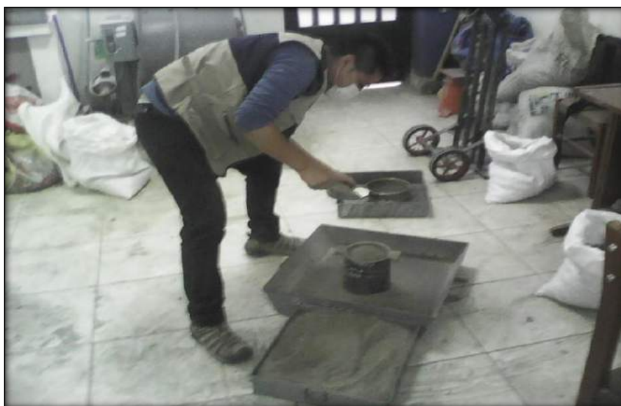
FOTO N° 06: Realizando los ensayos de pesos unitarios del agregado fino
