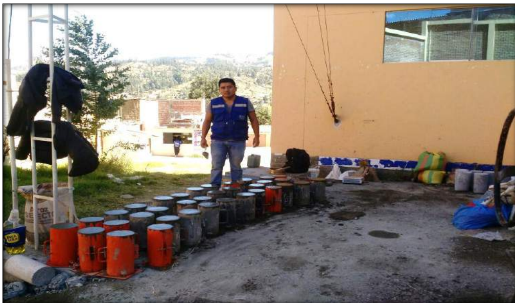
FOTO N° 13: Se observa las 36 probetas vaciadas 12 patrones, 12 sustituidas al 3% y 12 sustituidas en un 5% de cemento por ceniza de Huarango.
