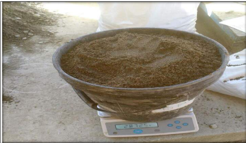
FOTO N° 09: Pesando el agregado fino que pasa por la malla N° 4, de acuerdo a los valores de diseño para su posterior mezcla.
