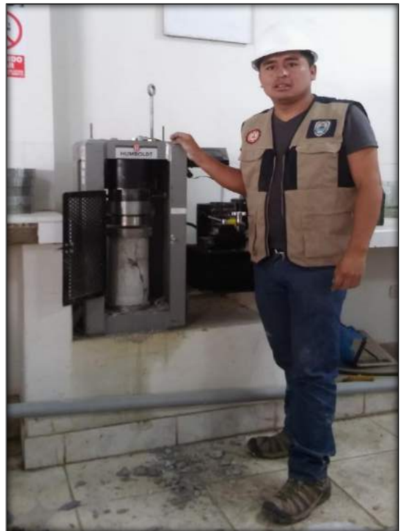
FOTO N° 17: rotura de las probetas. Realizando el ensayo de resistencia a la compresión.
