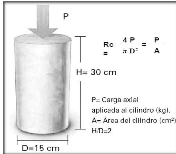
Figura N°- 2 Resistencia a la compresión.
