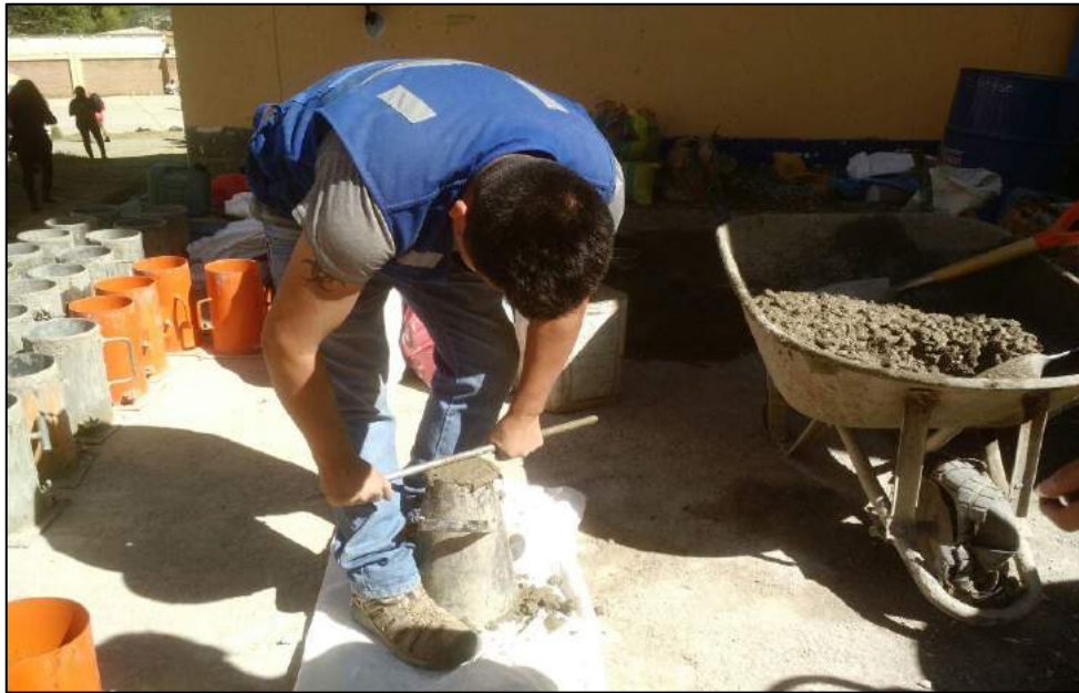
FOTO N° 12: Realizando la prueba del cono de Abrams.
