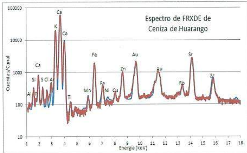
Figura 1. Espectro de FRXDE, es escala semilogarítmica, de una muestra de ceniza de huarango. Incluye el pico de Ar del aire y los picos de rayos-X de Au dispersados por la muestra. La curva en azul representa el espectro simulado
