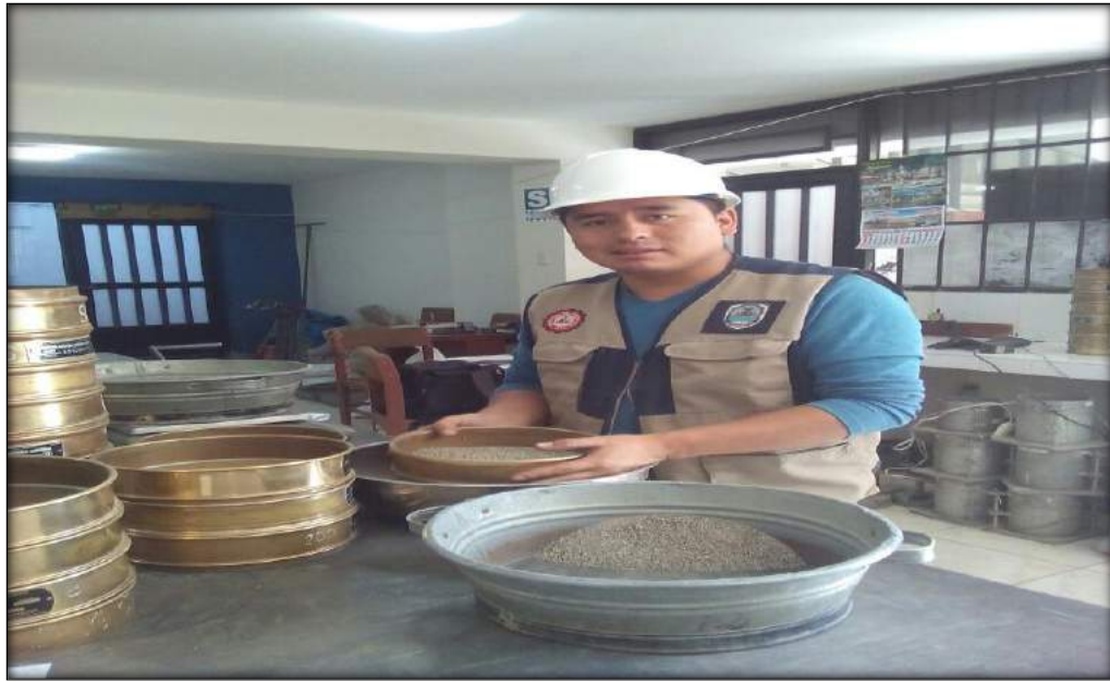
FOTO N° 08: Realizando la granulometría de los agregados.
