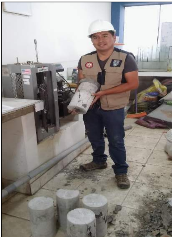
FOTO N° 17: rotura de las probetas. Realizando el ensayo de resistencia a la compresión.
