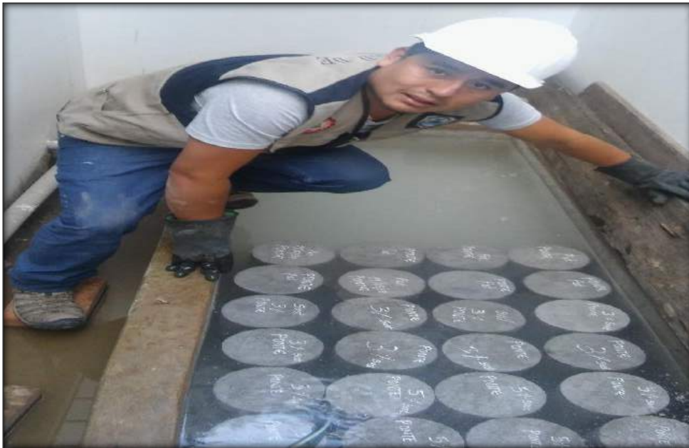
FOTO N° 15: Retirado de las probetas para su rotura 7 días de curado.
