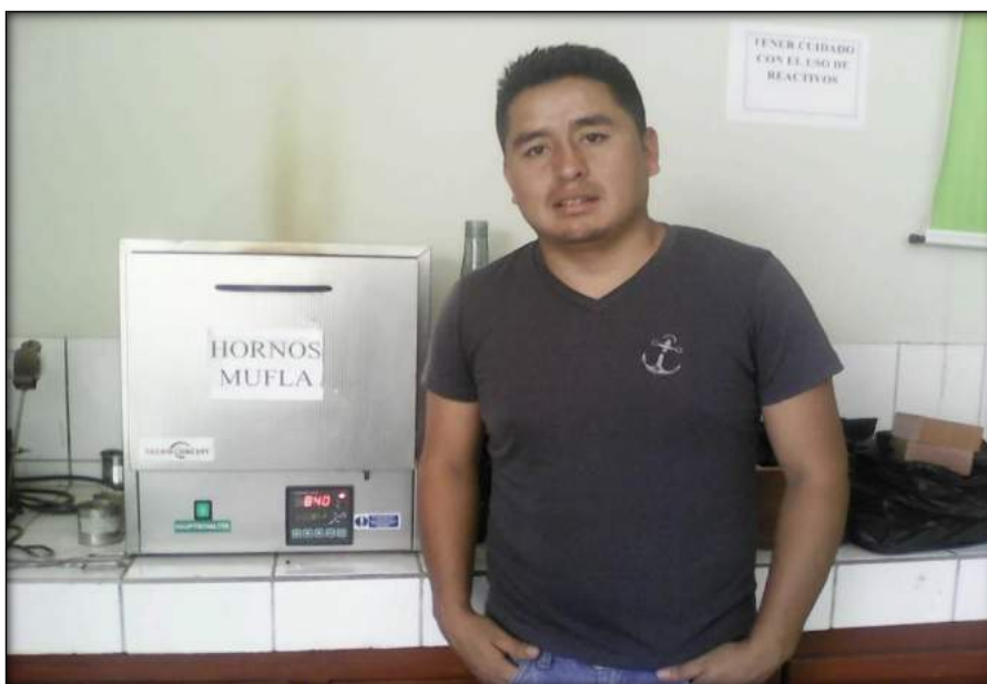
FOTO N° 04: Se calcino la madera de Huarango en 840 °C de acuerdo al análisis (ATD) realizado.
