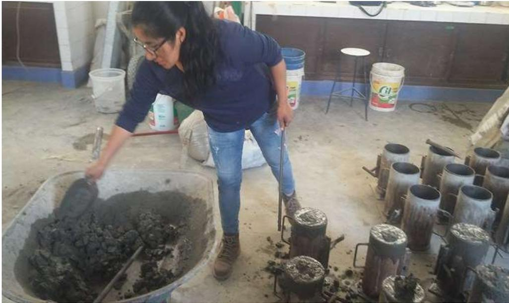
Fotografía 38: Espinoza, E (2018). Elaboración de probetas experimental en laboratorio de mecanica de suelos universidad san pedro Chimbote.
