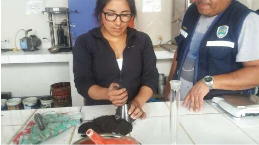
Fotografía 22: Espinoza, E (2018). Ensayo gravedad específica y absorción de viruta metálica en laboratorio de mecanica de suelos universidad san pedro Chimbote.
