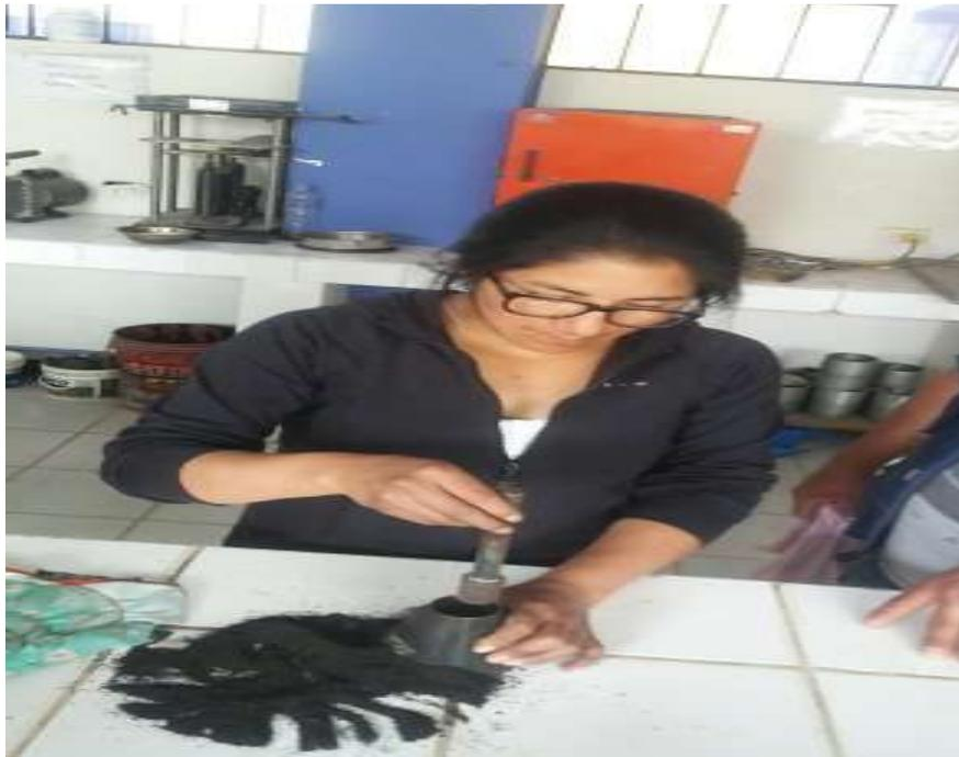
Fotografía 23: Espinoza, E (2018). Ensayo gravedad específica y absorción de viruta metálica en laboratorio de mecanica de suelos universidad san pedro Chimbote.
