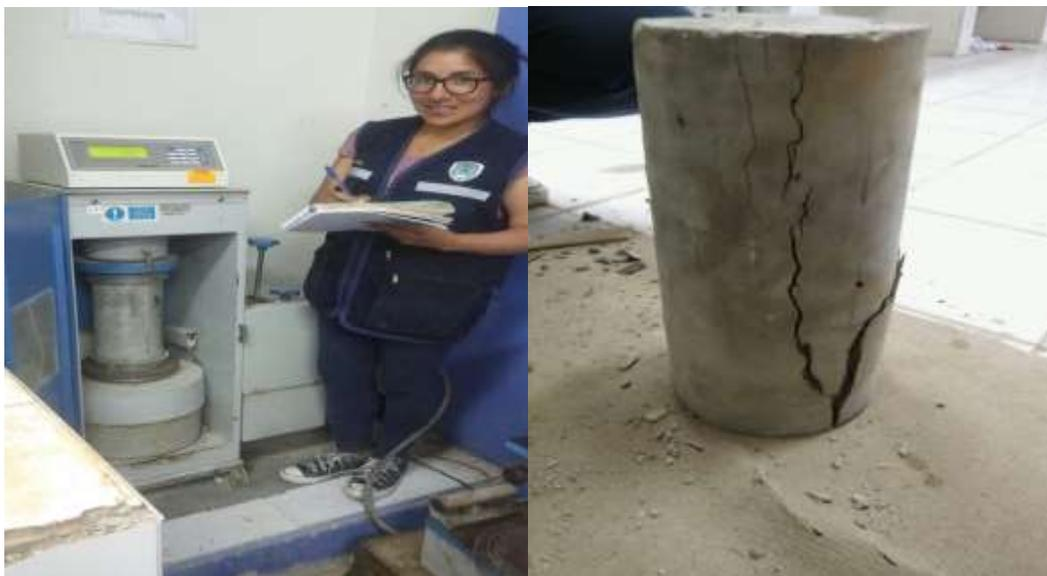
**Elaboración de mezclas de concreto experimental sustituyendo al agregado fino en un 10% por viruta metálica**
