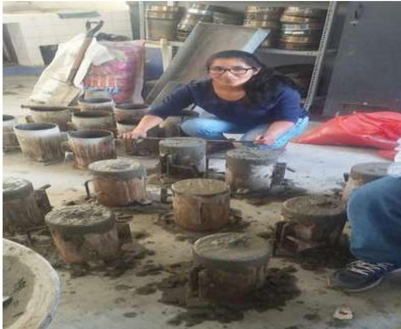
Fotografía 40: Espinoza, E (2018). Desencofrado de probetas a las 24 horas para ser sumergidas en la poza de curado en laboratorio de mecanica de suelos universidad san pedro Chimbote.
