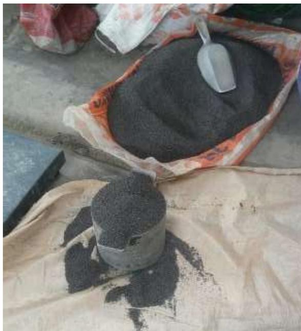
Fotografía 25: Espinoza, E (2018). Ensayo peso unitario suelto viruta metálica en laboratorio de mecanica de suelos universidad san pedro Chimbote.
