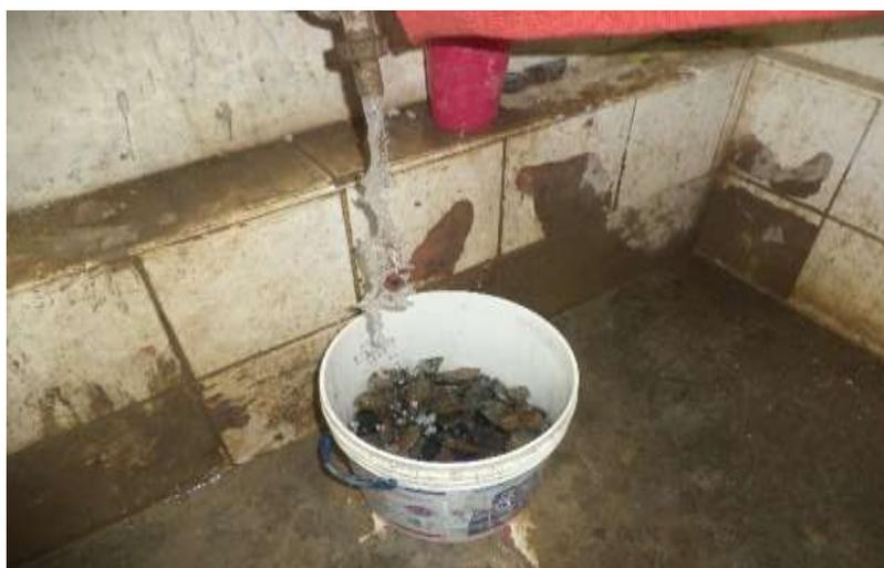
Fotografía 15: Espinoza, E (2018). Ensayo gravedad específica y absorcion agregado grueso en laboratorio de mecanica de suelos universidad san pedro Chimbote.
