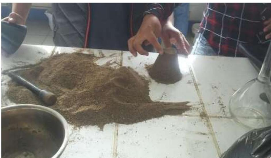
Fotografía 9: Espinoza, E (2018). Ensayo gravedad específica y absorción agregado fino en laboratorio de mecanica de suelos universidad san pedro Chimbote.
