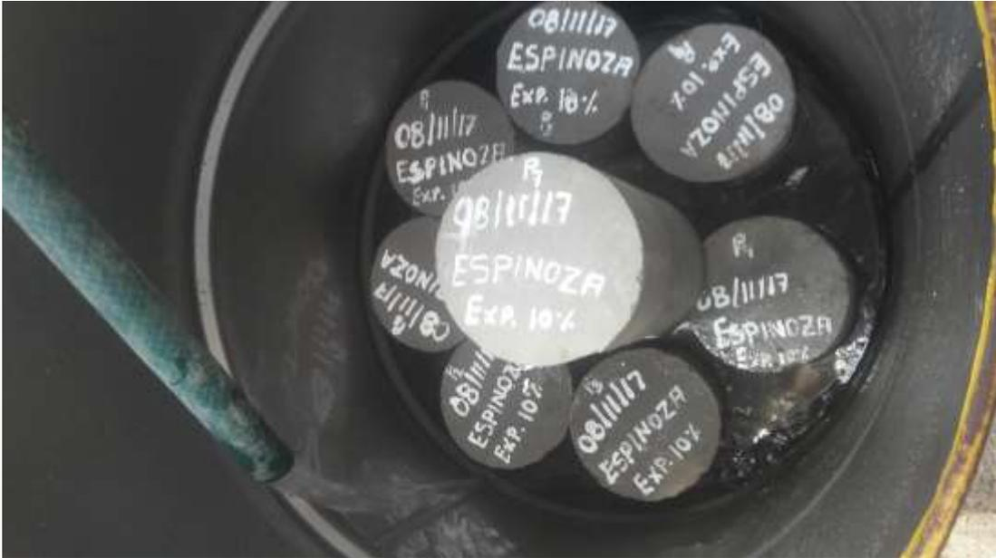
Fotografía 42: Espinoza, E (2018). Pesos de probetas en laboratorio de mecanica de suelos universidad san pedro Chimbote.
