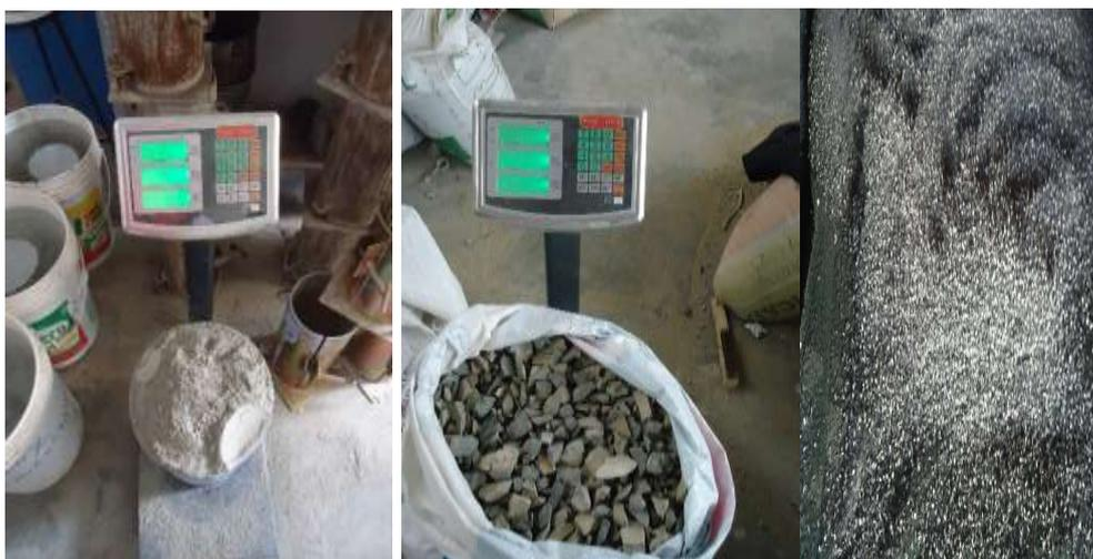
Fotografía 35: Espinoza, E (2018). Elaboración de la mezcla de concreto con viruta metálica en laboratorio de mecanica de suelos universidad san pedro Chimbote.
