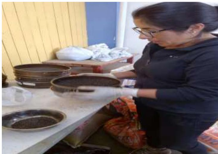
Fotografía 19: Espinoza, E (2018). Ensayo granulometría viruta metálica en laboratorio de mecanica de suelos universidad san pedro Chimbote.
