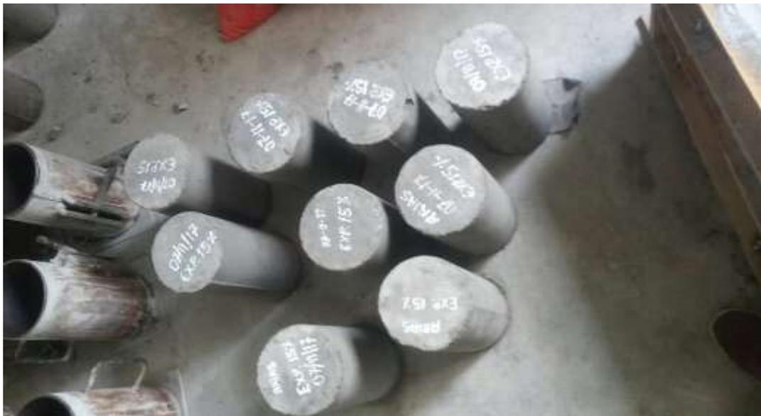
Fotografía 41: Espinoza, E (2018). Curado de probetas en la poza de curado para luego ser ensayadas a compresión a los 7, 14 y 28 días en laboratorio de mecanica de suelos universidad san pedro Chimbote.
