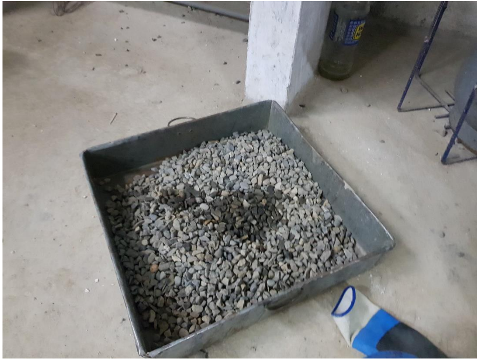
Obtención de agregado grueso de \frac{1}{2} " de la Cantera Rola – Huaraz.
