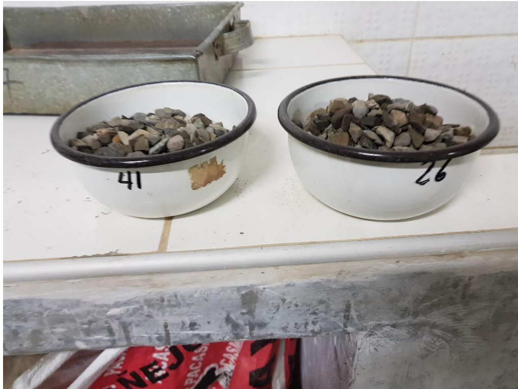
Determinación del contenido de humedad del agregado grueso.
