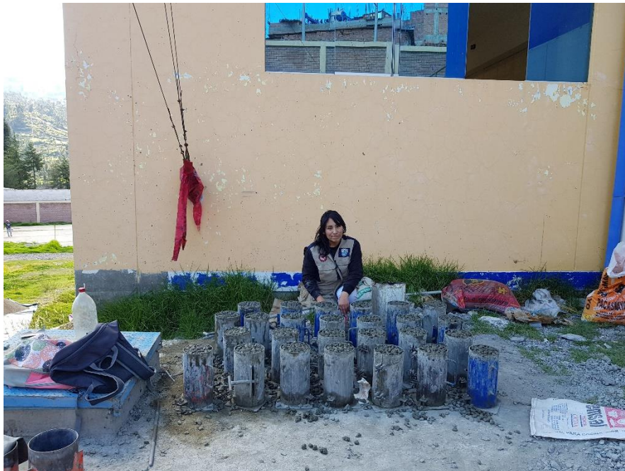
Probetas terminadas para el ensayo de resistencia a la compresión con 20% y 30% de vacíos.
