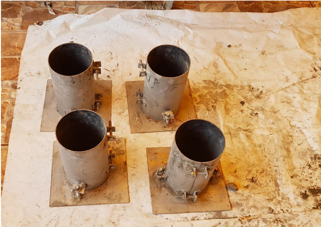
Moldes para la elaboración de probetas para el ensayo de permeabilidad.
