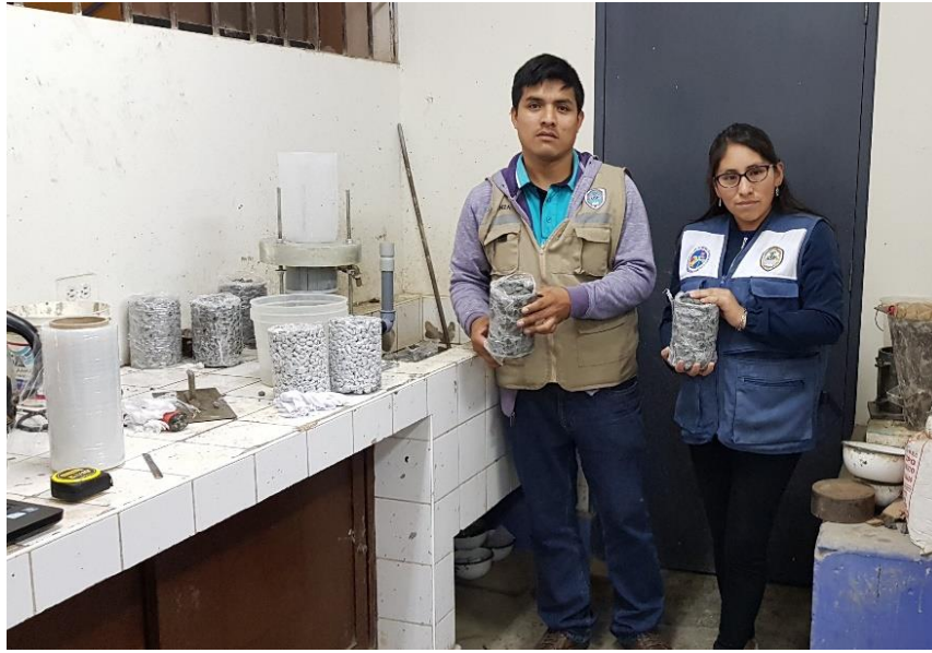
Figura N° 30. Ensayo de Permeabilidad.
