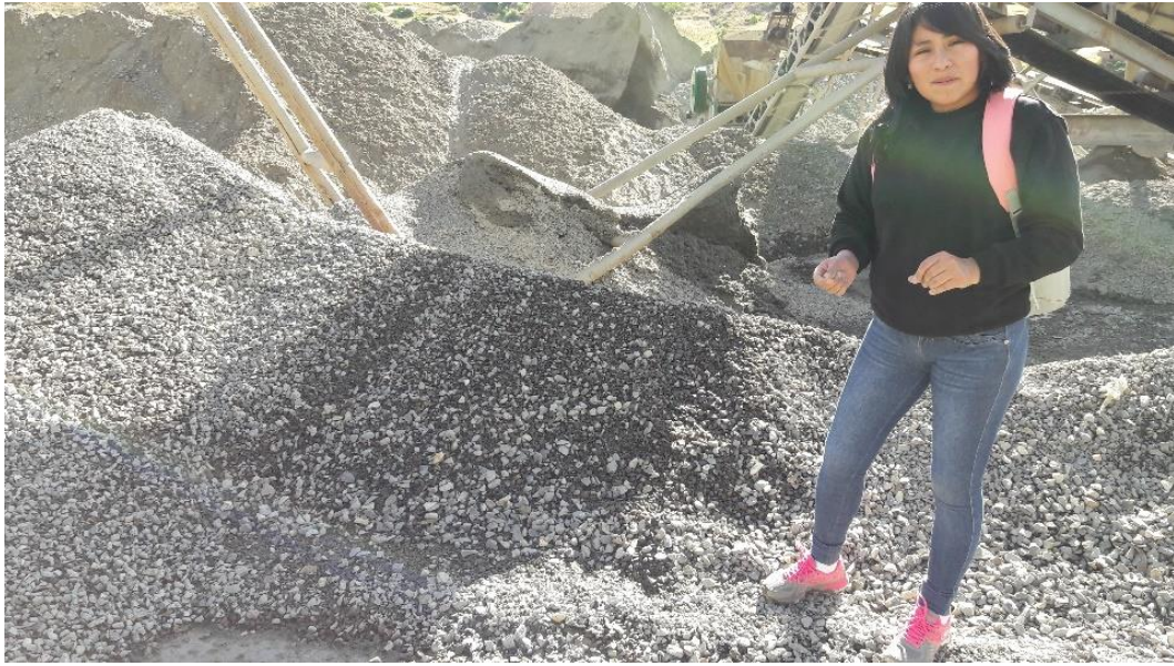
Figura N° 12. Piedra chancada de ½" de la Cantera Rola - Huaraz.
