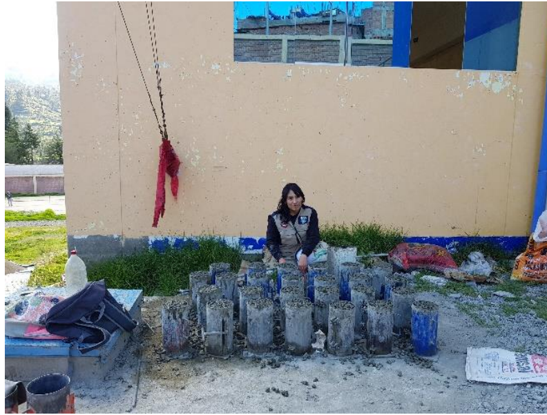
Figura N° 26. Elaboración de Probetas Para el Ensayo de Resistencia a la Compresión.
