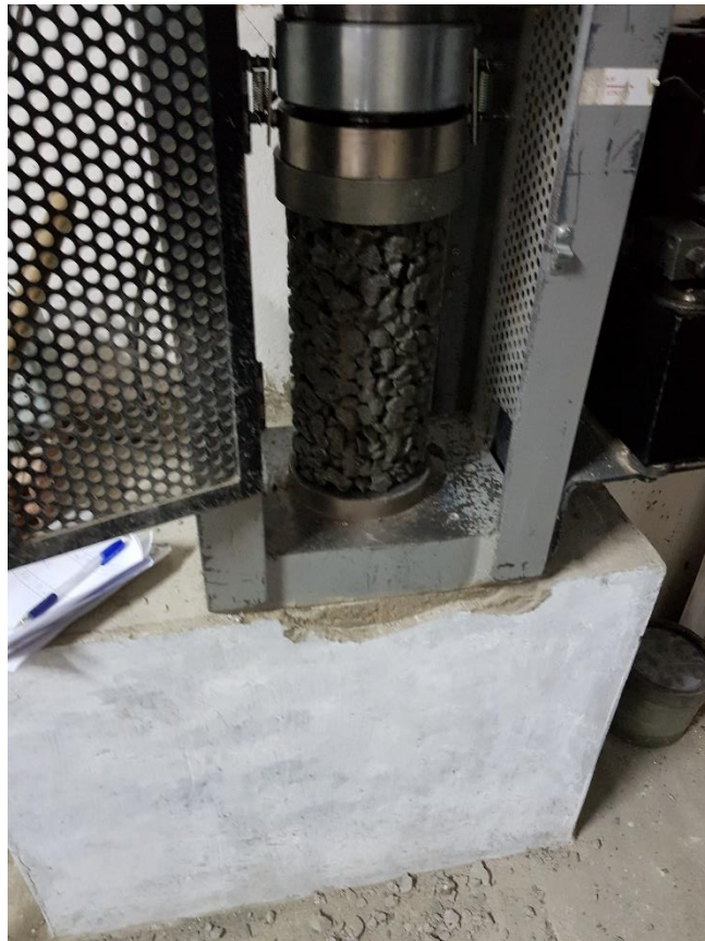
Ensayo de resistencia a la compresión.
