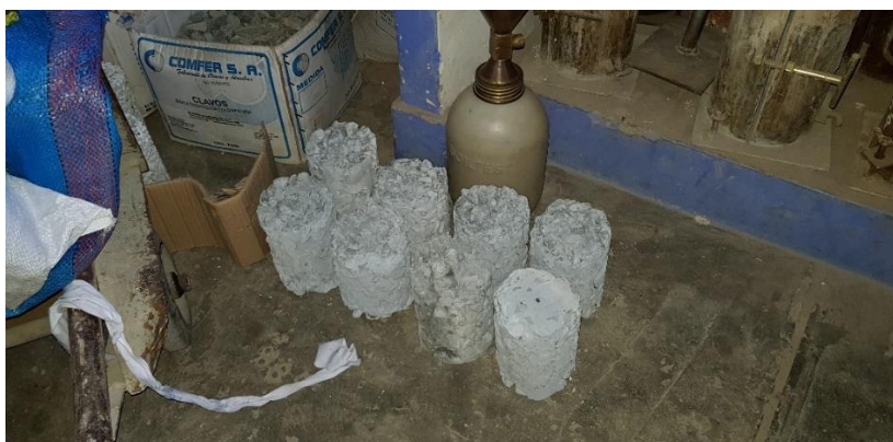
Figura N° 29. Elaboración de Probetas Para el Ensayo de Permeabilidad.
