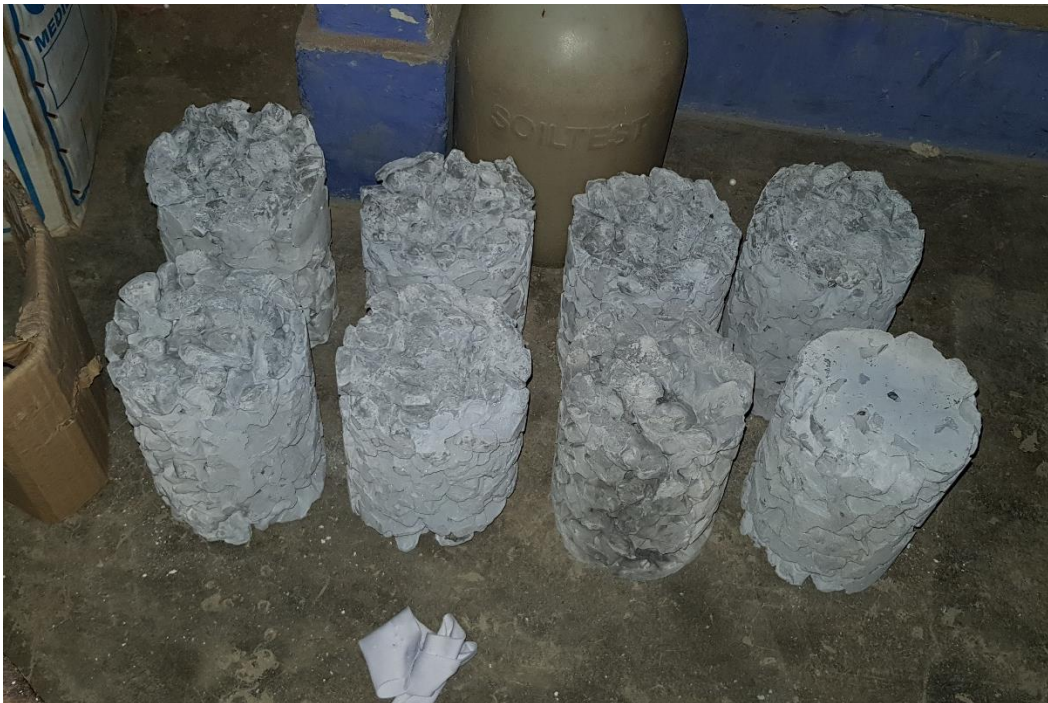
Probetas ya elaboradas para el ensayo de permeabilidad al 20% y 30% de vacíos, 04 probetas por cada porcentaje.
