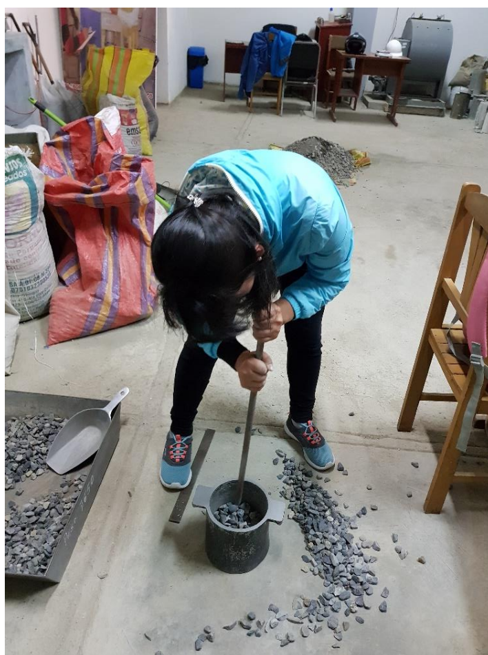
Figura N° 25. Prueba del Peso Unitario Compactado.
