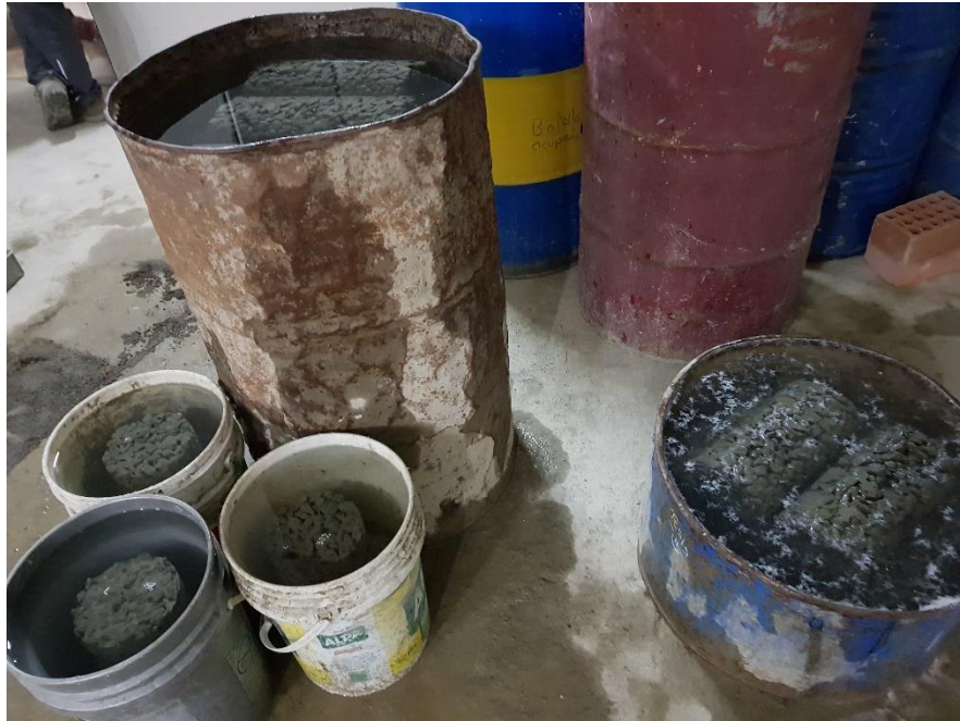
Probetas sometidas al curado, para la realización del ensayo a la compresión.
