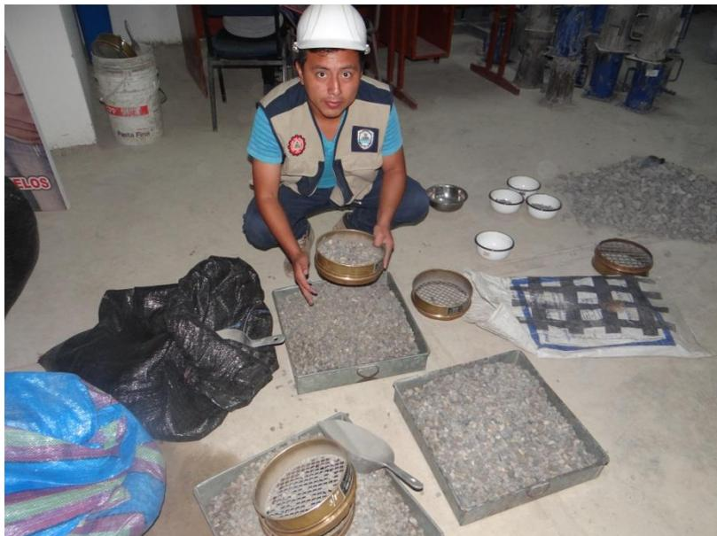
**FOTO N° 04:** Tamizado de los agregados para retirar impurezas
