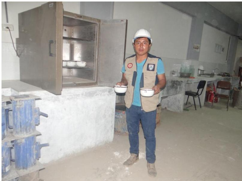
**FOTO N° 06:** Muestra de agregados sometidos al horno para obtener el contenido de humedad.
