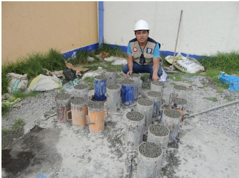
**FOTO N° 14:** Probetas listas con su respectivo compactado.
