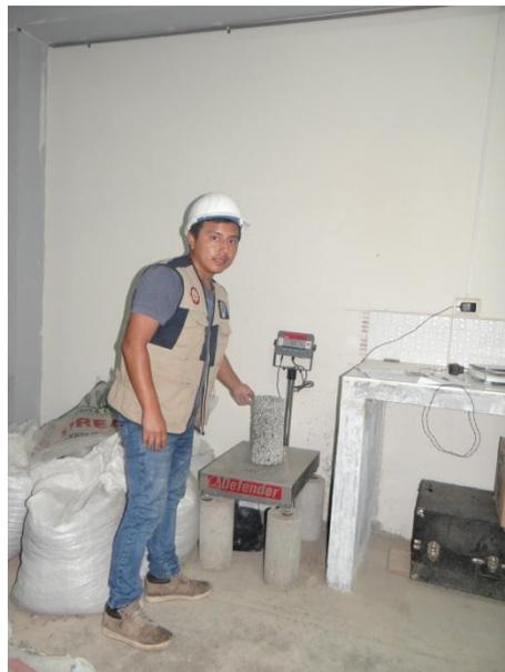
**FOTO N° 16:** Pesado del molde de concreto seco listo para su compresión.
