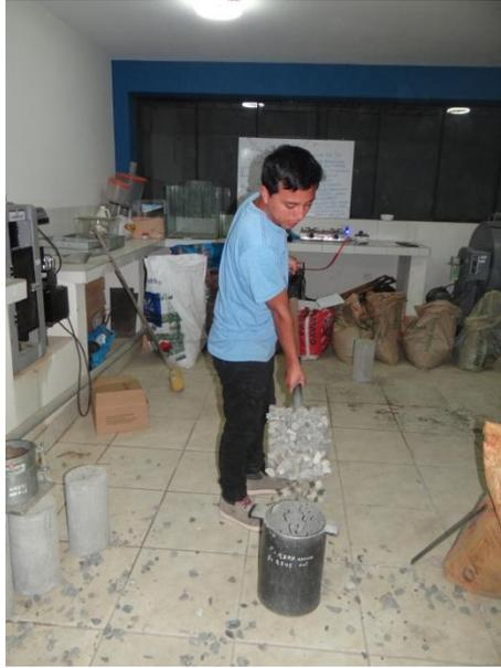
**FOTO N° 09:** Muestra de agregados para la gravedad el peso unitario compactado
