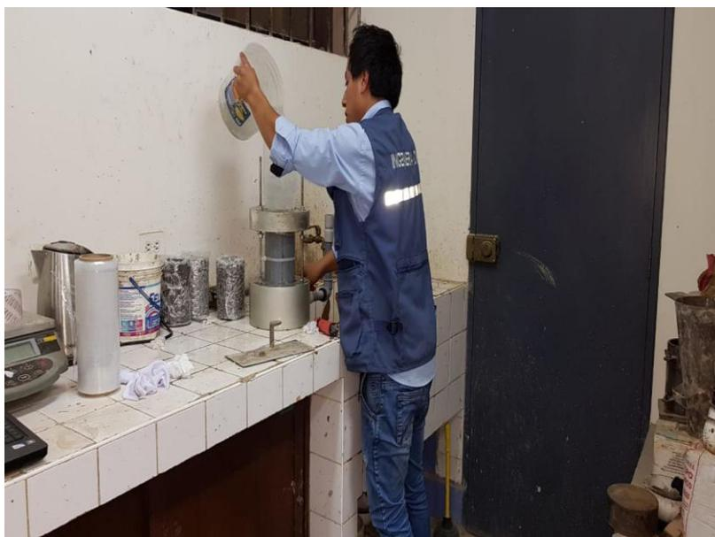
**FOTO N° 22:** Los moldes asegurados se empieza a saturar de agua con una medida de 20 cm.
