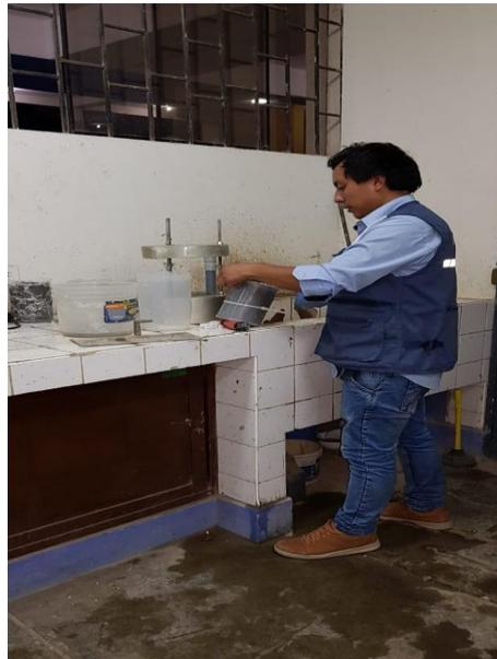
**FOTO N° 20:** Molde de 10 x 15 cm asegurado para no tener perdida de agua.
