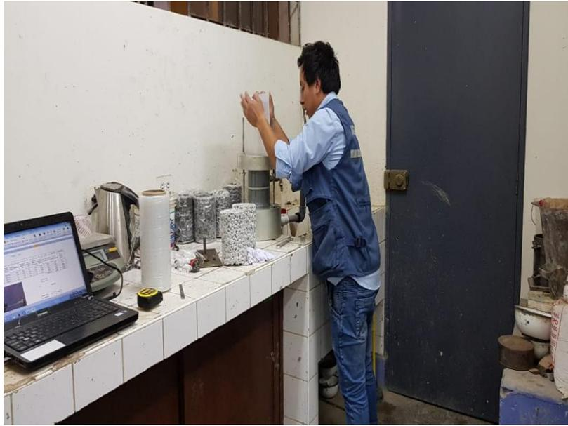
**FOTO N° 23:** Calculados los 20 cm de agua se procede a abrir la llave y contabilizar los segundos en que tarda en pasar todo los 20 cm. De agua.
