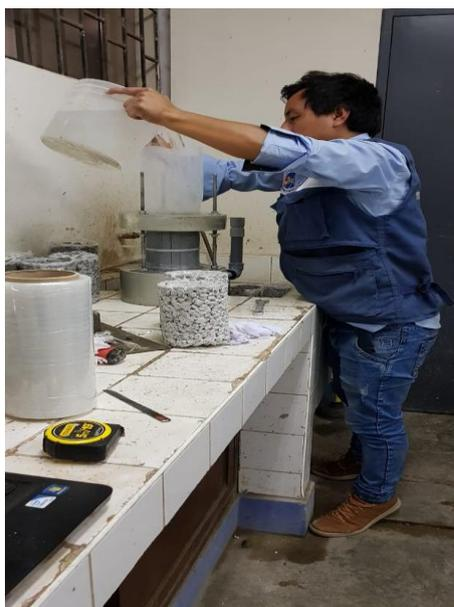
**FOTO N° 21:** Los moldes asegurados se empieza a saturar de agua con una medida de 20 cm.
