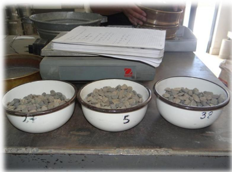
**FOTO N° 07:** Muestra de agregados para la gravedad específica y absorción.
