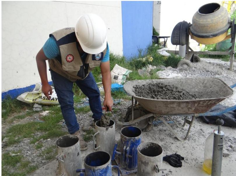
**FOTO N° 12:** Enmoldamiento de las probetas
