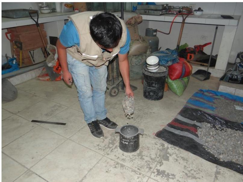
**FOTO N° 08:** Muestra de agregados para la gravedad el peso unitario suelto
