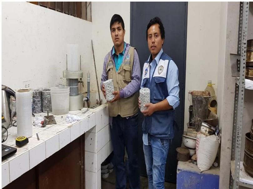
**FOTO N° 18:** Moldes preparados para la colocación en el permeámetro.
