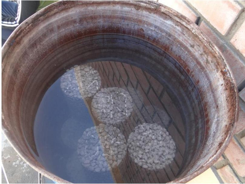
**FOTO N° 15:** Probetas desmoldadas y en proceso de curado.
