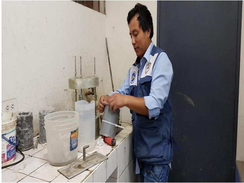
**FOTO N° 19:** Molde de 10 x 15 cm asegurado para no tener perdida de agua.
