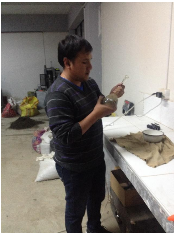
Foto N° 04: Procedimiento para determinar el peso específico y porcentaje de absorción del agregado fino.
