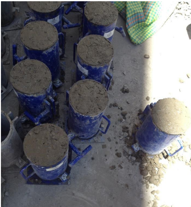
Foto N o 10: Concreto en los cilindros.
