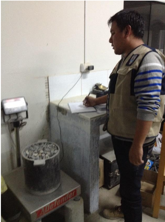
Foto N° 03: Tomando datos para determinar el peso unitario del agregado grueso.
