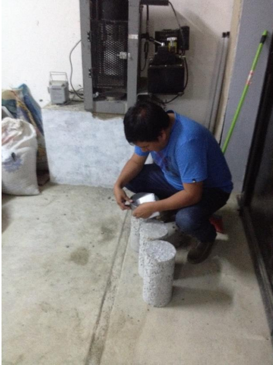
Foto N o 11: Acondicionando la probeta para la prueba de resistencia a la compresión.
