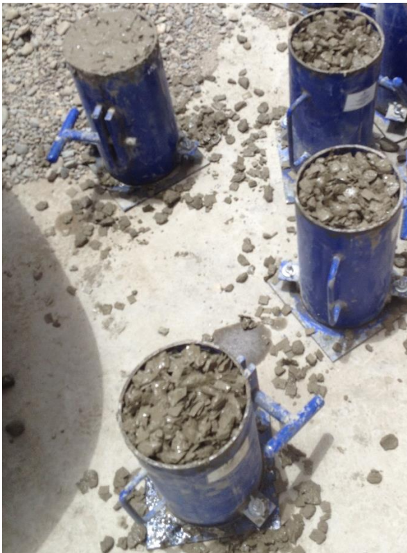
Foto N a 08: Segregación del concreto con sustitución del agregado grueso por material de reciclaje; plástico.
