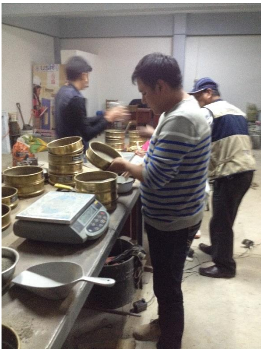
Foto N o 02: Realizando la granulometría del agregado fino.
