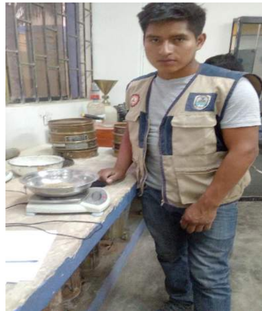
Fotografía N° 22: Peso del agregado fino para el contenido de humedad
