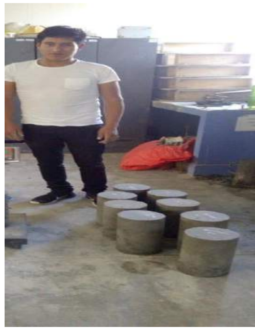
Fotografía N° 38: Desencofrado de las probetas patrón. Fotografía N° 39: Probetas patrón
