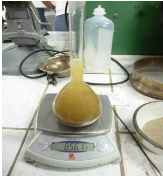
Fotografía N° 29: Peso del picnómetro con agua.
