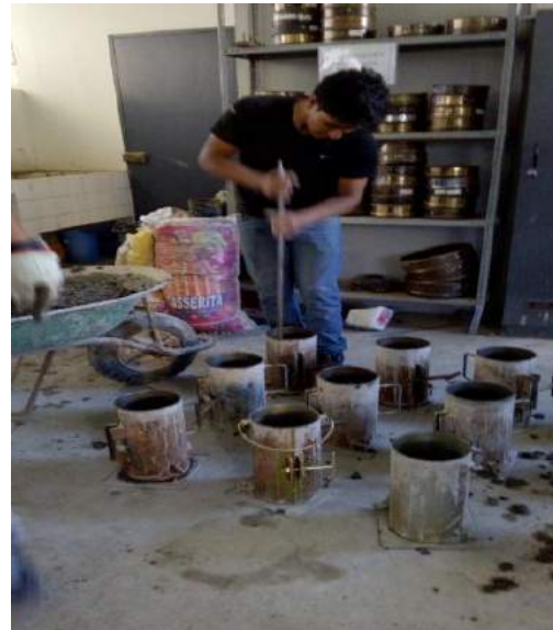
Fotografía N° 37: Chuseado del concreto
