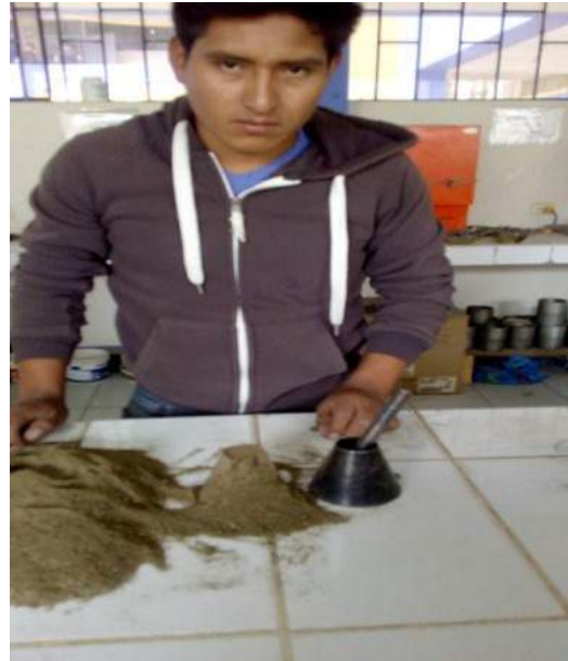
Fotografía N° 28: Material después del llenado en el molde
