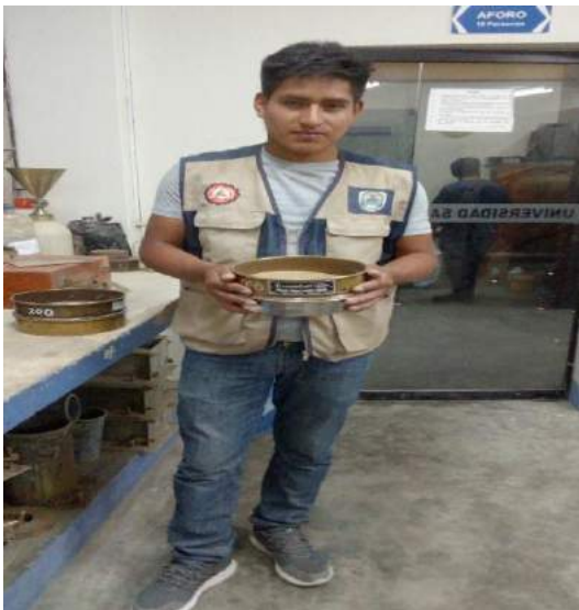
Fotografía N° 17: Tamizando el agregado fino
