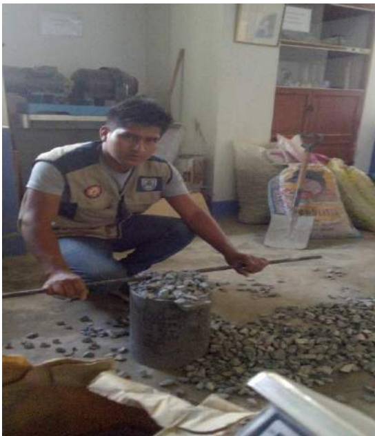
Fotografía N° 21: enrazado del agregado grueso
