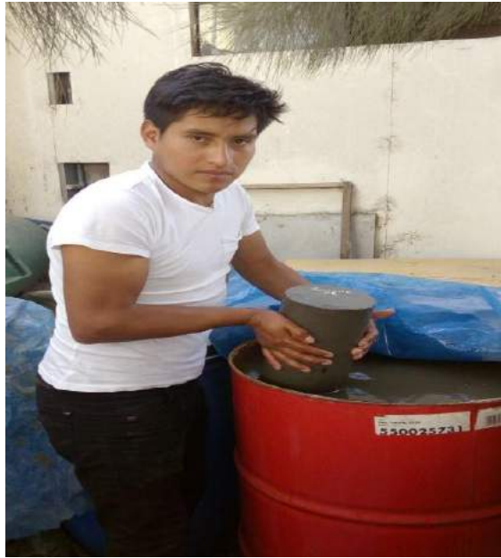
Fotografía N° 46: curado de probetas experimenta
