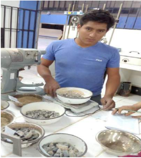
Fotografía N° 23: Pesado del agregado grueso
