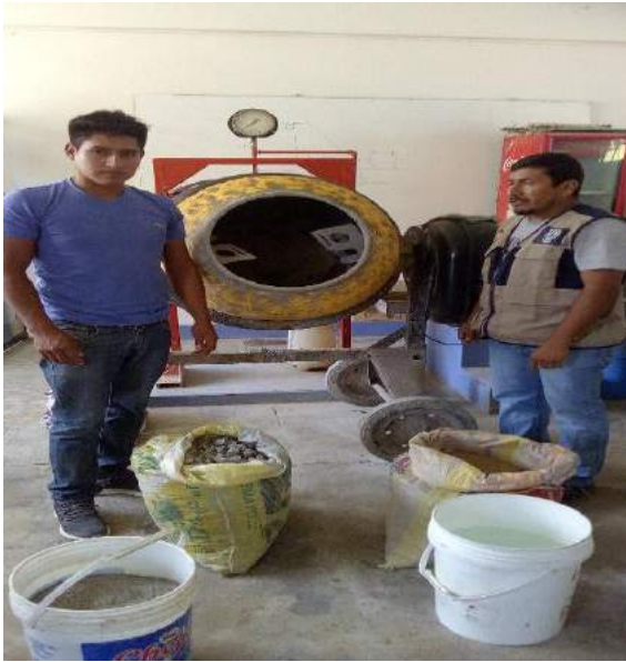
Fotografía N° 34: Mescla de los materiales en el trompo.
