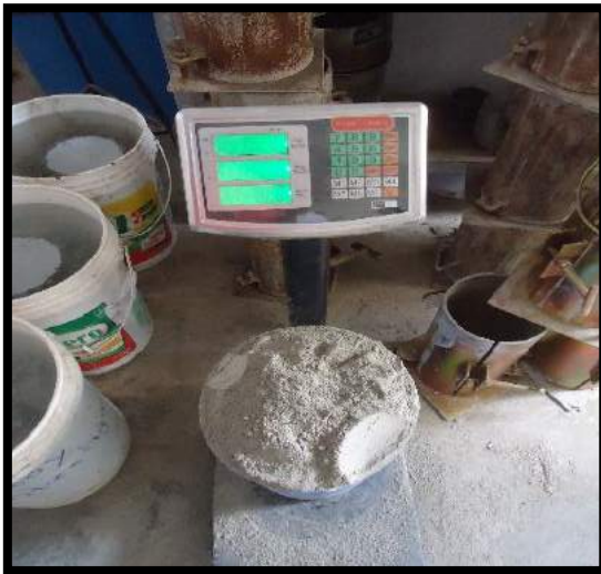
Fotografía N° 32: Peso del cemento
