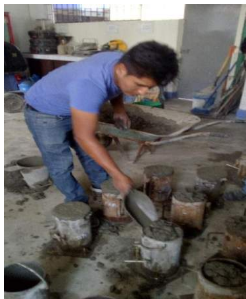
Fotografía N° 45: Llenado de las probetas con la combinación de ceniza de ichu (12%)
