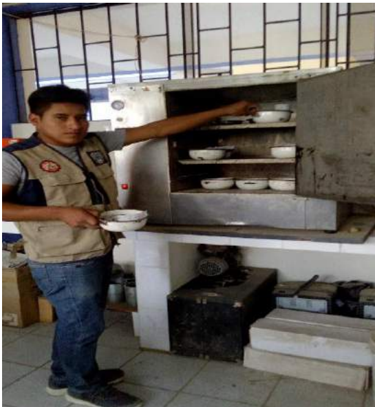
Fotografía N° 25: Colocando las taras en el horno.
