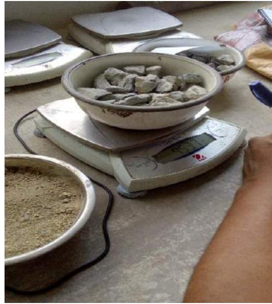
Fotografía N° 24: Material pesado y en taras
