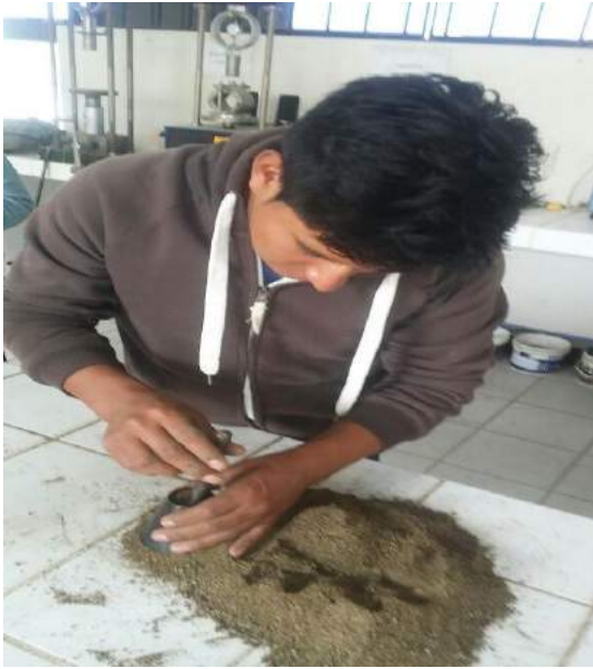
Fotografía N° 27: Material llenado en el molde.
