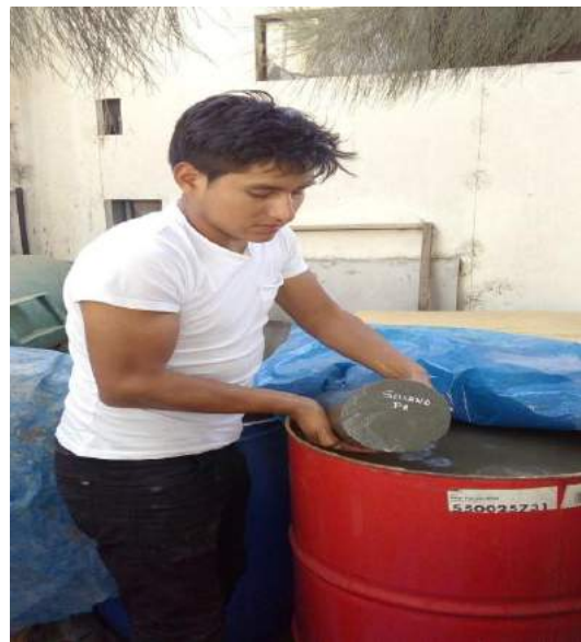
Fotografía N° 41: Curado de las probetas .
