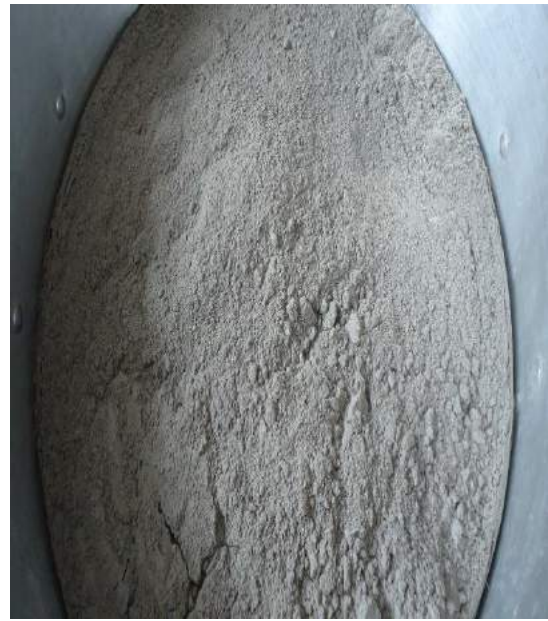
Fotografía N° 08: La Ceniza fue Tamizada para una mayor trabajabilidad
