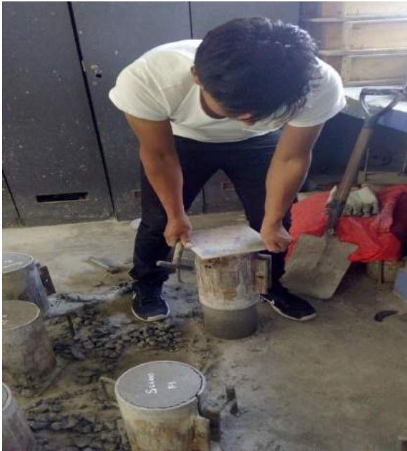
Fotografía N° 38: Desencofrado de las probetas patrón. Fotografía N° 39: Probetas patrón
