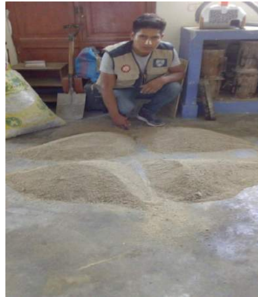
Fotografía N° 16: cuarteo de agregado fino.
