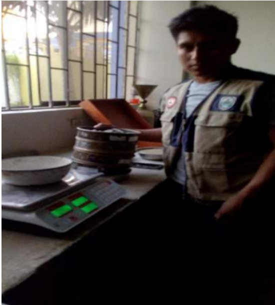
Fotografía N° 15: tamizando el agregado grueso
