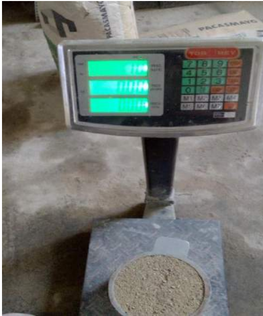
Fotografía N° 19: peso del agregado fino
