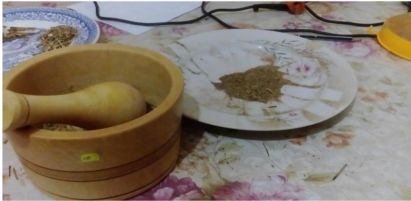
**FIGURA N° 39: MOLIDO DE LA MUESTRA EN MORTERO HASTA OBTENER UNA MUESTRA FINA**
