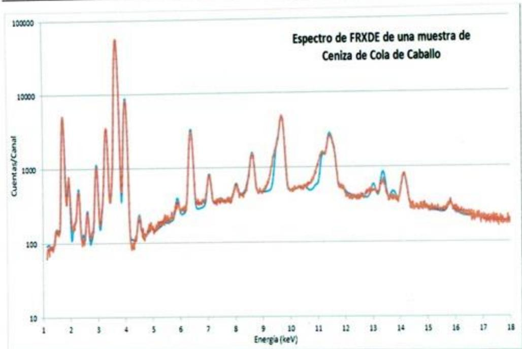
Figura 1. Espectro de FRXDE de una mezcla de cemento y ceniza de cola de caballo en escala semi logarítmica. Incluye el pico de Ar del aire y los picos de rayos-X de Au dispersados por la muestra. La curva en azul muestra el espectro simulado
