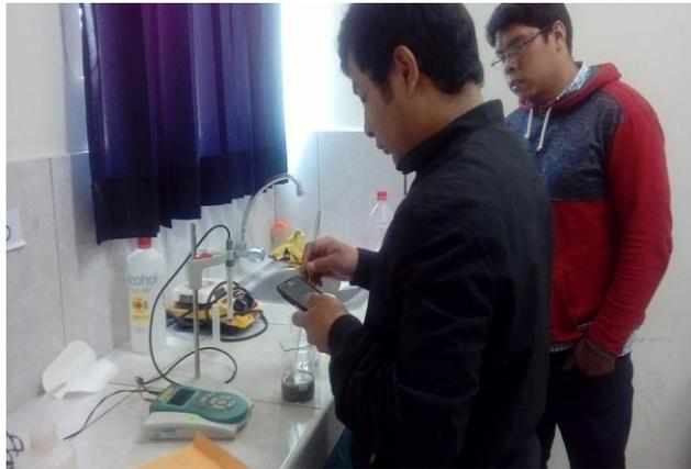
**FIGURA N° 45:** PROCEDIMIENTO PARA EL CALCULO DEL PH DE LA CENIZA DE COLA DE CABALLO, CEMENTO TIPO I Y LA COMBINACION DE AMBOSCON 15% DE SUSTITUCION.
