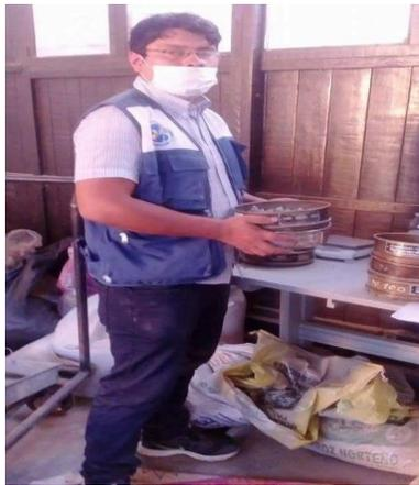
**FIGURA N° 49: ANALISIS GRANULOMETRICO DEL AGREGADO GRUESO**
