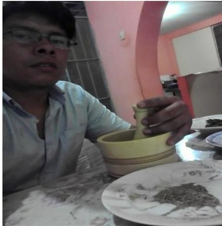
**FIGURA N° 40: MOLIDO DE LA MUESTRA EN MORTERO HASTA OBTENER UNA MUESTRA FINA**
