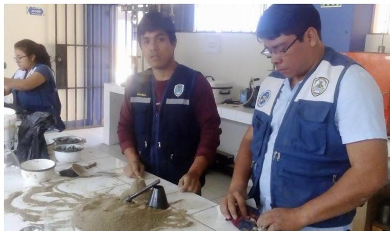
**FIGURA N° 56: PESO ESPECÍFICO DE LA MASA DEL AGREGADO FINO**
