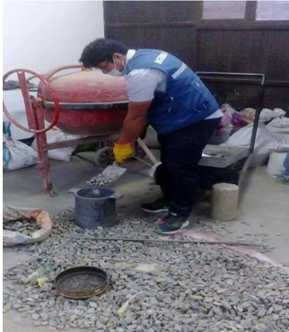
**FIGURA N° 51: PESO UNITARIO Y COMPACTADO DEL AGREGADO GRUESO**
