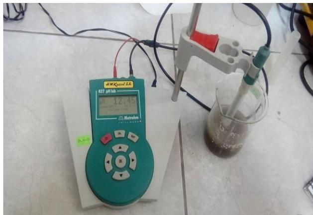
**FIGURA N° 44:** EQUIPO UTILIZADO PARA EL CALCULO DEL PH DE LA CENIZA DE COLA DE CABALLO, CEMENTO TIPO I Y LA COMBINACION DE AMBOS CON 15% DE SUSTITUCION.
