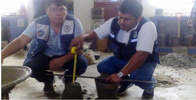
**FIGURA N° 58: PRUEBA DEL SLUMP**
