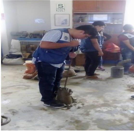
**FIGURA N° 57: PRUEBA DEL SLUMP**
