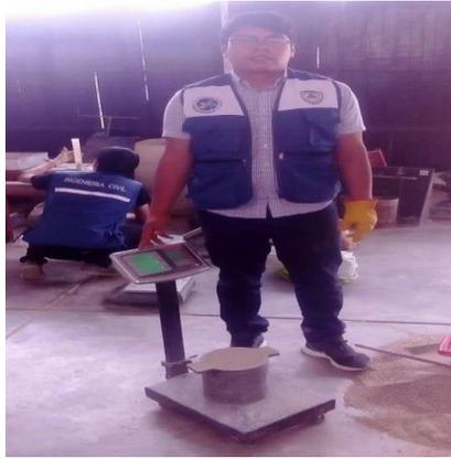
**FIGURA N° 52: PESO UNITARIO Y COMPACTADO DEL AGREGADO FINO**
