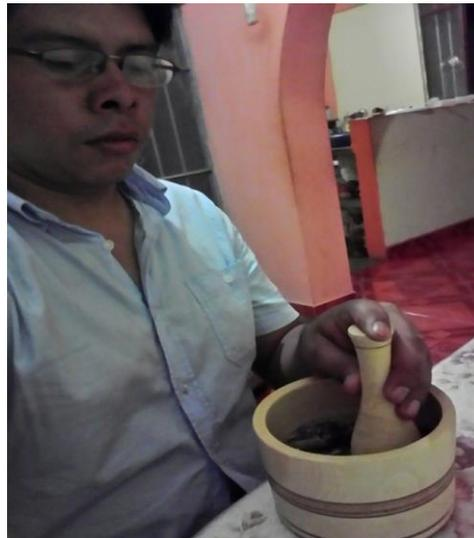
**FIGURA N°38:** MOLIDO DE LA MUESTRA EN MORTERO HASTA OBTENER UNA MUESTRA FINA
