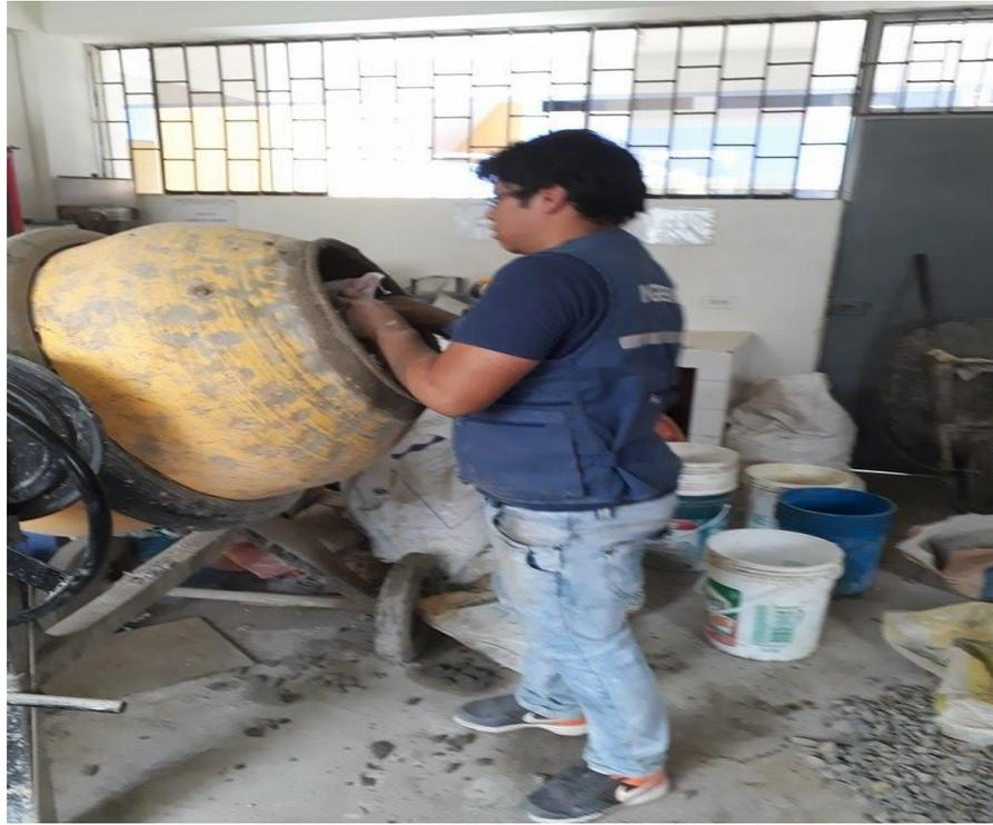
**FIGURA N° 62: ELABORACION DE LA MEZCLA DE CONCRETO ESPERIMENTAL**
