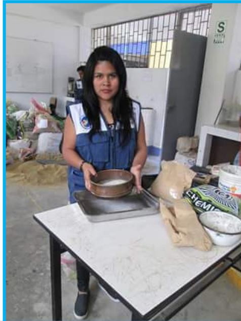
**Foto 9.** Se observa el tamizado de las cenizas con la malla #200, en el laboratorio de la USP.
