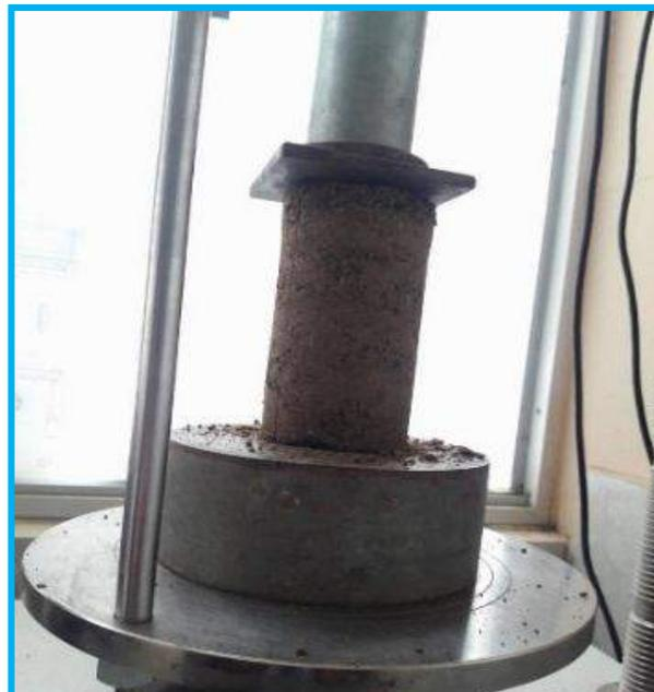
**Foto 22.** Se observa la muestra cilíndrica remodelada, en el cual consiste en comprimir la muestra, que va midiendo la deformación y la carga aplicada a través del tiempo.
