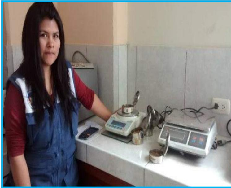
**Foto 19.** Se observa el pesaje de las taras, y golpes de las muestras cilíndricas - Ensayo de Paredes no confinadas, en el laboratorio de Cerámicos y Suelos.
