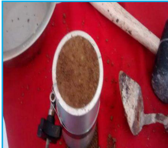
**Foto 20.** Se observa las muestras cilíndricas remoldeadas - Ensayo Compresion no confinadas.
