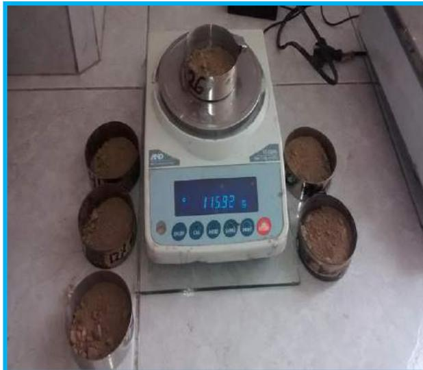
**Foto 18.** Se muestra el secado y peso de las muestras en las taras, para el ensayo de Paredes No Confinadas, en el laboratorio de Cerámicos y Suelos en la UNT.
