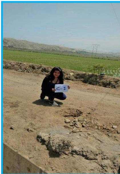
**Foto 2.** Se observa la calicata, donde se recogió la muestra para los ensayos.
