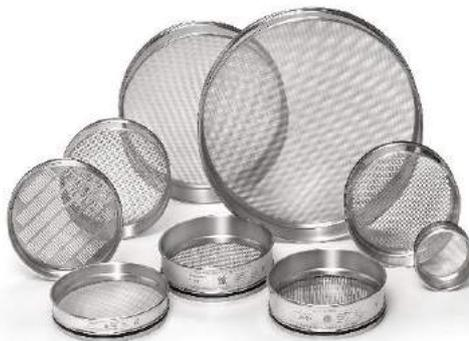
Figura 1: Análisis Granulométrico por tamizado.
