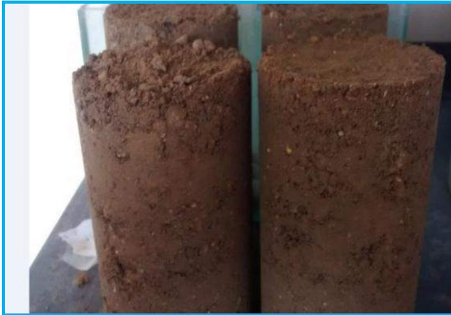
**Foto21.** Se observa la muestra Cilíndrica a los 7 y 14 días desmoldadas.
