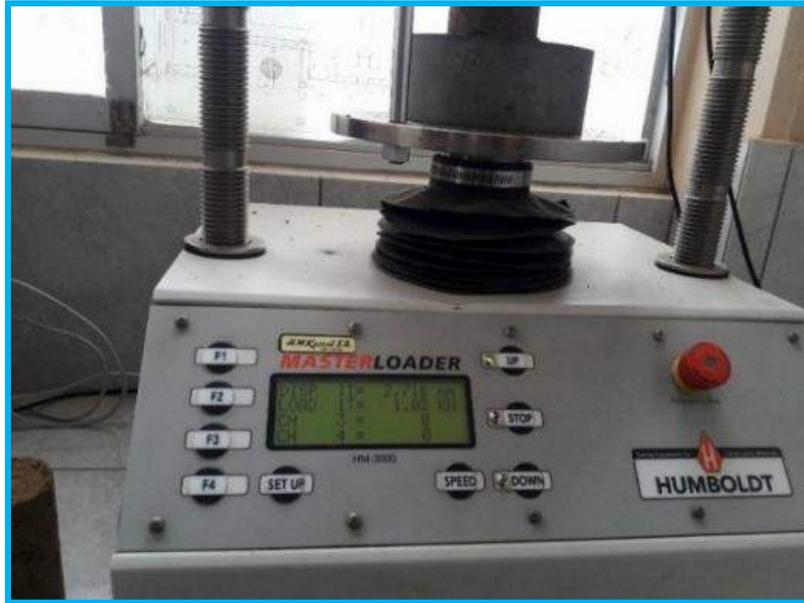
**Foto 23.** Se observa la rotura de las muestras cilíndricas remoldeadas, para ver los resultados de esfuerzo y desplazamiento por el método de Paredes No confinadas.
