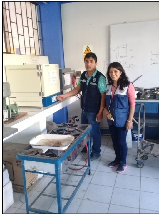
Figura 7: colocación de muestra a la mufla 600 C° por un tiempo de 2 horas
