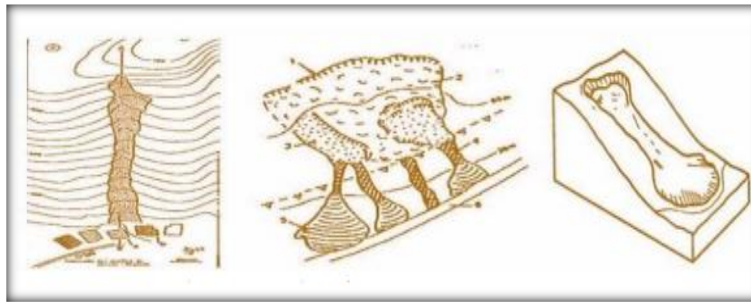
Figura 13: Coladas o Flujos
