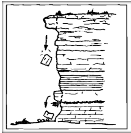
Figura 16: Desprendimiento de roca debido a la alternancia de roca competente con roca débil
