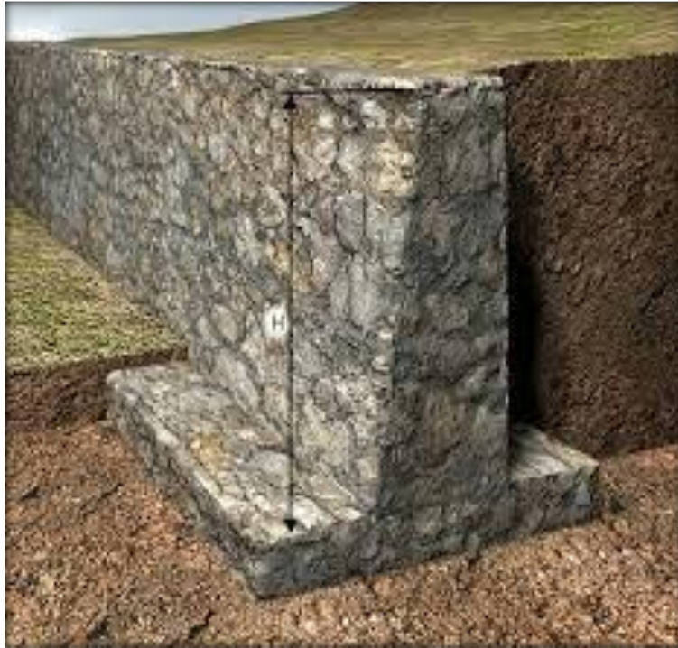
Figura 03: Estabilización de Talud con Muro de Contención
