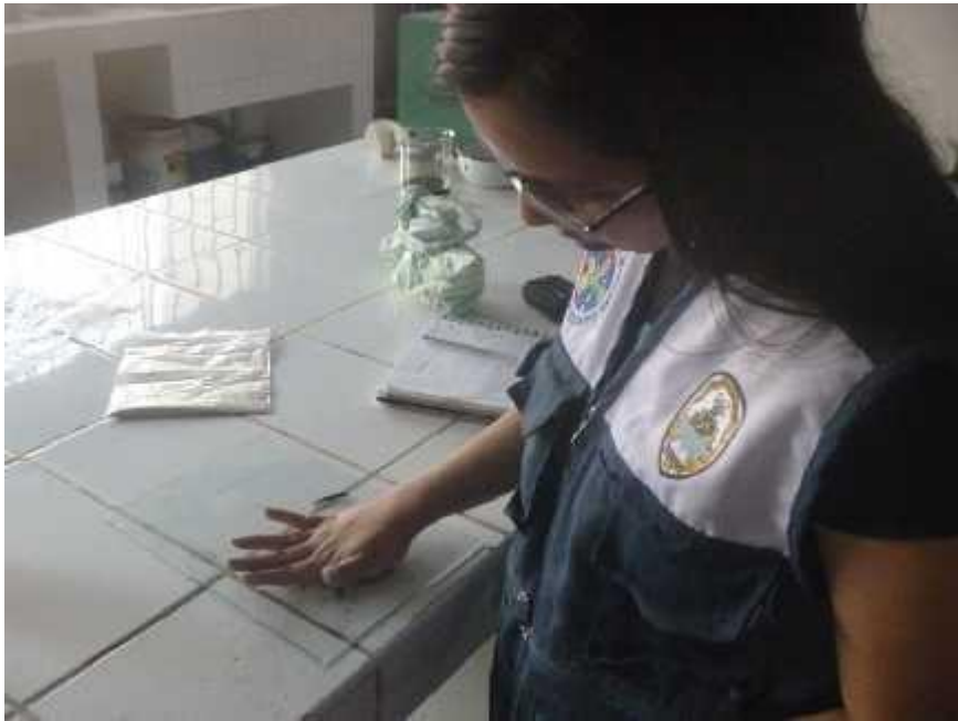
Foto N°05: Realizando el límite plástico de la arcilla
