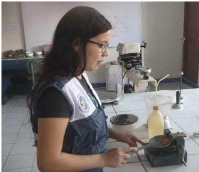
Foto N°04: Realizando el límite líquido de la arcilla usando la cuchara de Casagrande
