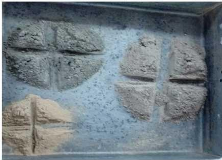
Foto N°08: Cuarteo de los materiales que se utilizaran para la elaboración de las pastas experimentales
