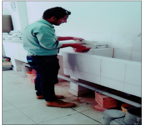
Foto N°21: Lavado del Agregado Grueso.
