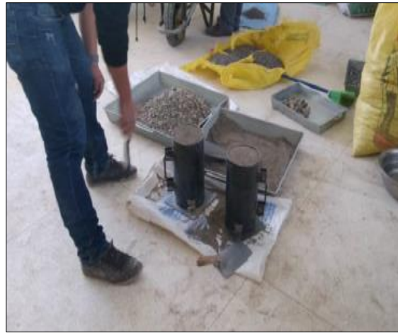
Foto N°25: Enrasado del recipiente con la muestra para el cálculo del Peso Unitario Suelo Ag. Fino
