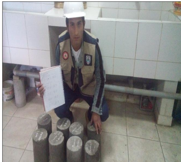
Foto N°47: Apunte de las Roturas en 28 días.
