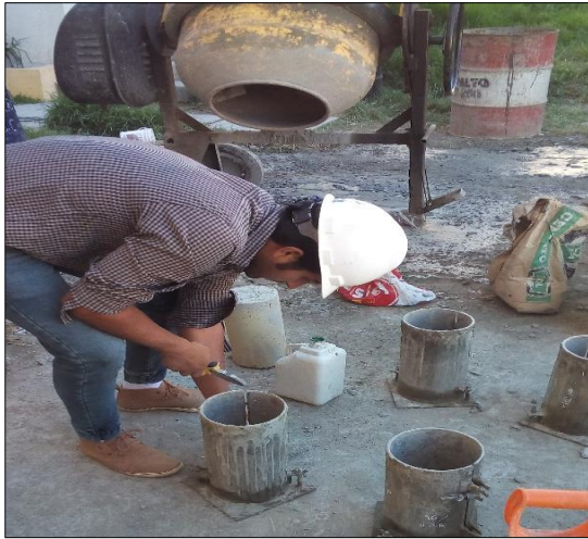
Foto N° 28: Herramientas para la elaboración de las probetas.
