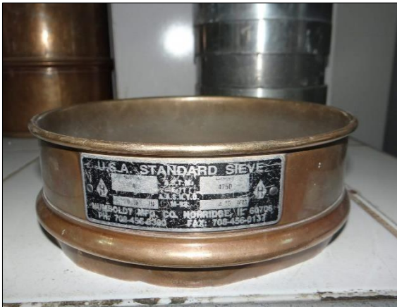
Foto N°9: Malla para el ensayo Granulométrico Ag. Fino
