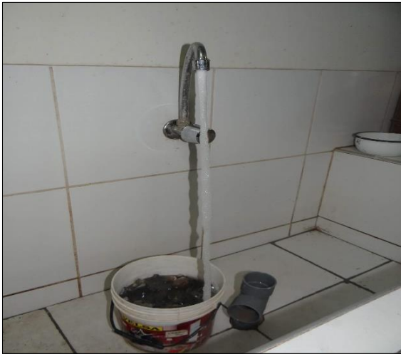
Foto N°20: Lavado del Agregado Fino.
