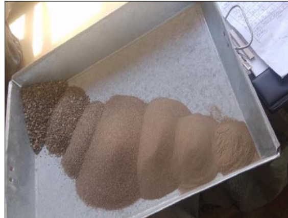
Foto N°15: Tamizado del Agregado Grueso (Grava)
