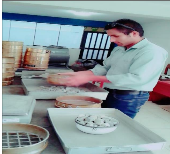
Foto N°13: Tamizando los Agregados.
