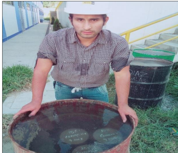
Foto N°41: Curado de las probetas en un cilindro.
