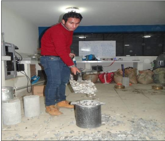
Foto N°24: Enrasado del recipiente con la muestra para el cálculo del Peso Unitario Suelo Ag. Fino
