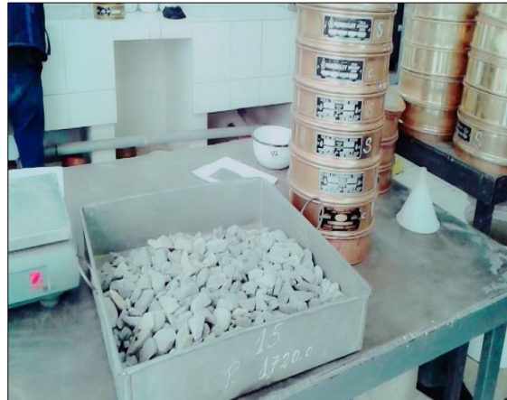
Foto N°10: Mallas con respectivos N° para el ensayo Granulométrico
