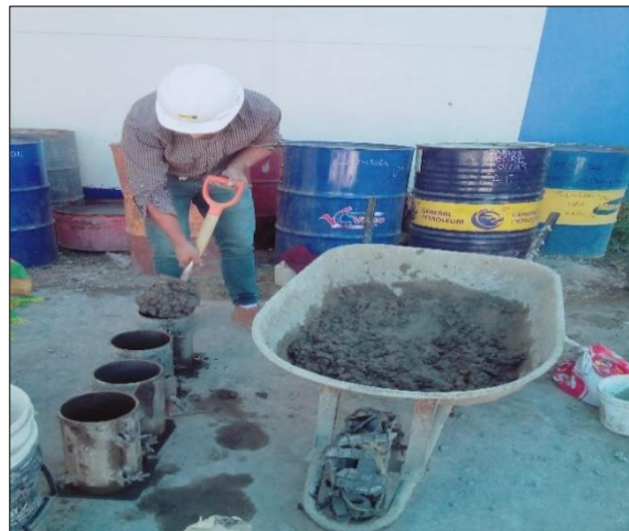
Foto N°35: Llenado del concreto en diferentes probetas.
