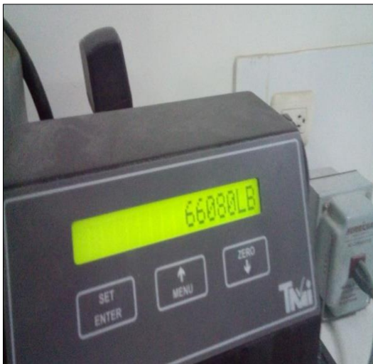
Foto N°46: Se observa en la rotura de una de las probetas en Lb.
