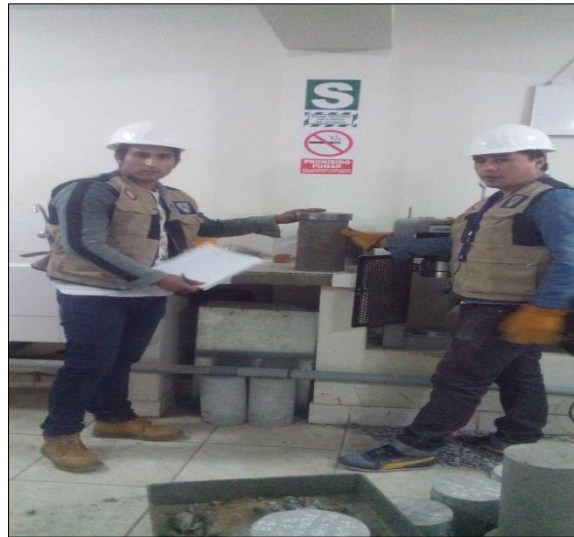
Foto N°45: Rotura a los 28 días de su elaboración.
