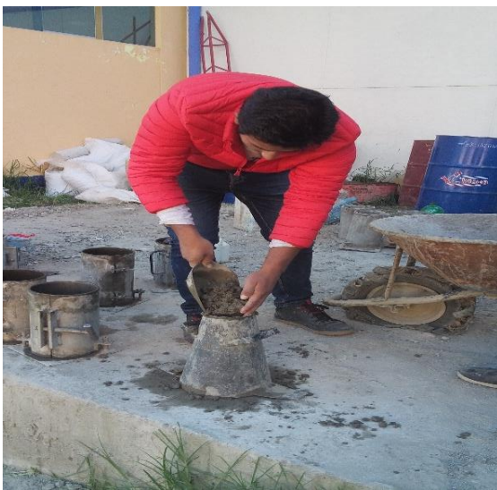
Foto N°26: Elaboración del Slump.
