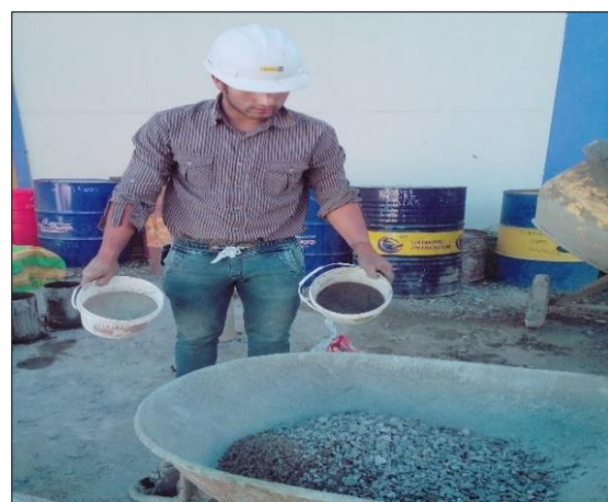
Foto N°33: Comparación del cemento con la ceniza de hoja de pino
