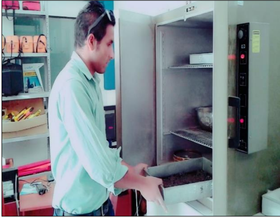
Foto N°18: Colocando el recipiente en el horno.
