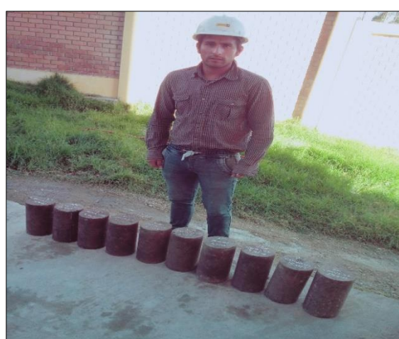
Foto N°39: Desencofrado para ser curado en diferentes días.
