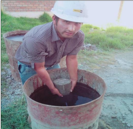
Foto N°40: Colocado de las primeras muestras al cilindro
