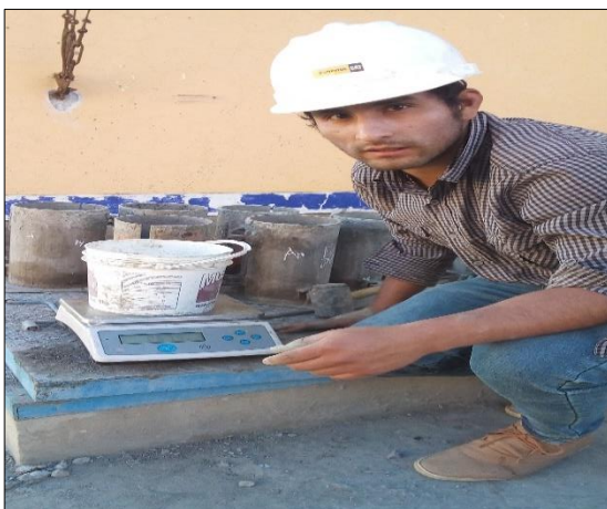
Foto N°32: Pesando los materiales para la elaboración de probetas.
