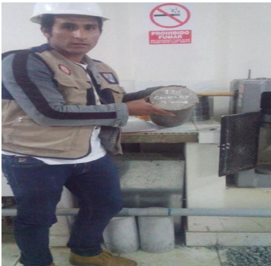
Foto N°42: Muestra de la probeta de 15% de ceniza de hoja de pino
