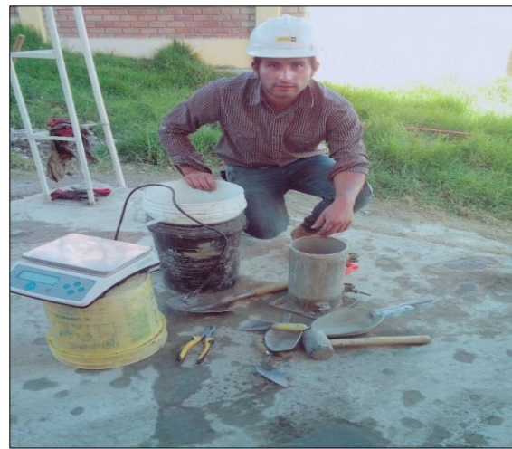
Foto N° 29: Colocado de los moldes en una superficie nivelada.
