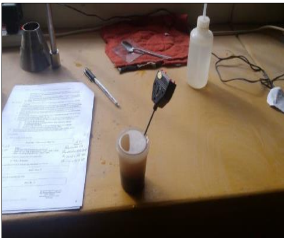
Foto N°22: Enrasado del picnómetro con material incluido.
