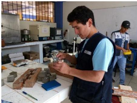
FOTOGRAFIA N°51: Medición con el Vernier los Diametros
