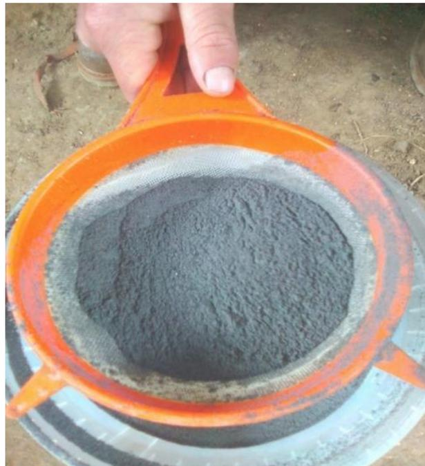
FOTOGRAFIA N°10: Tamizar la ceniza para la separación de carbones.
