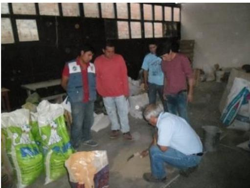
FOTOGRAFIA N°23: Cuarteo del Agregado Fino en el laboratorio de la USP
