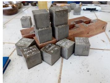
FOTOGRAFIA N°49 - 50: Desencofrado de los morteros
