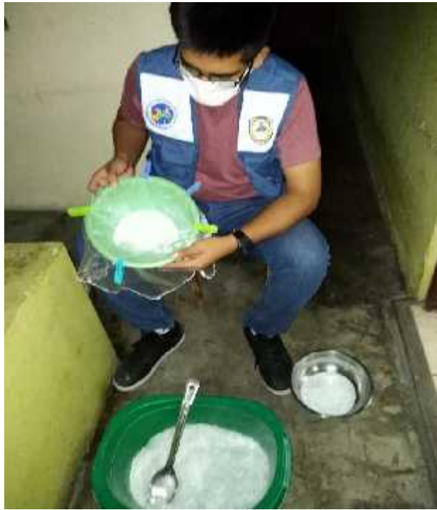
Foto N°05: Separación de tamaño de partícula más fina del vidrio mediante la organiza
