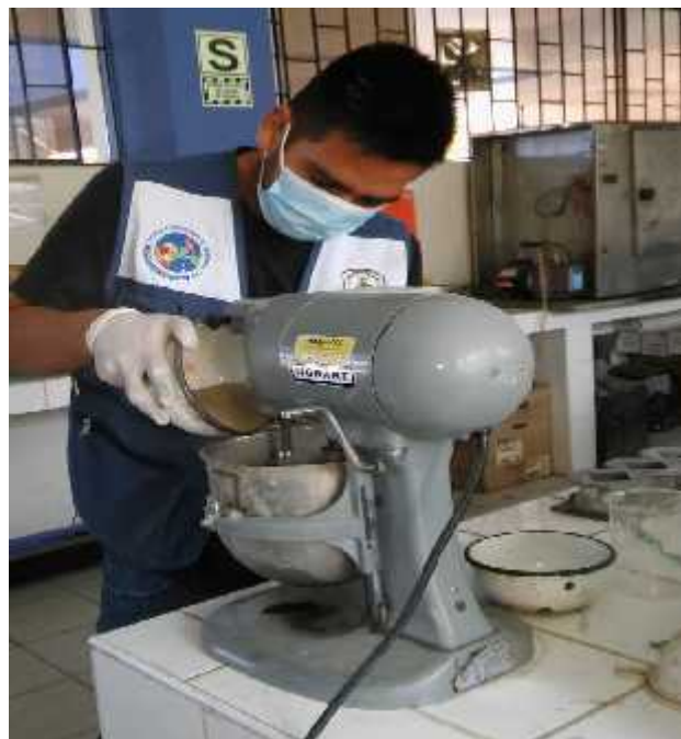
Foto N°20: Preparación de la mezcla de mortero
