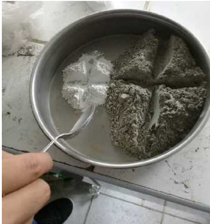
Foto N°17: Proceso de combinación del Polvo de Vidrio, Ceniza de Concha de Abanico y cemento
