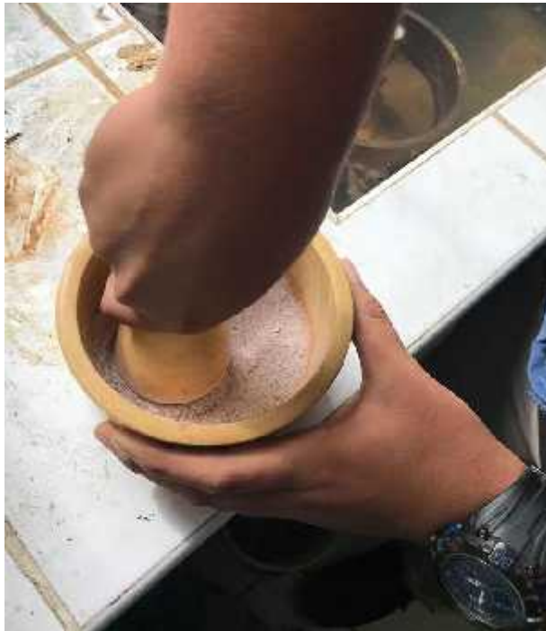
Foto N°10: Proceso de Trituración de la Concha de Abanico con Mortero
