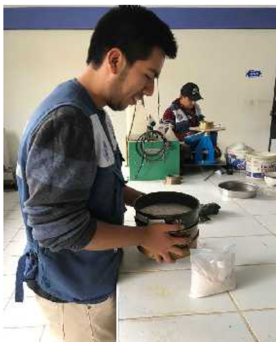
Foto N° 11: Tamizado de la Concha de Abanico por la Malla N°200
