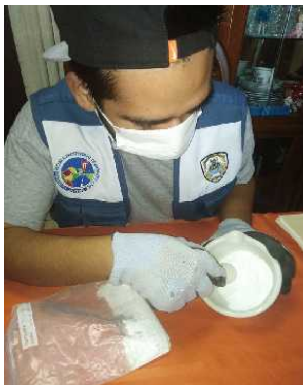
Foto N°14: Trituración de Cenizas de Concha de Abanico con mortero
