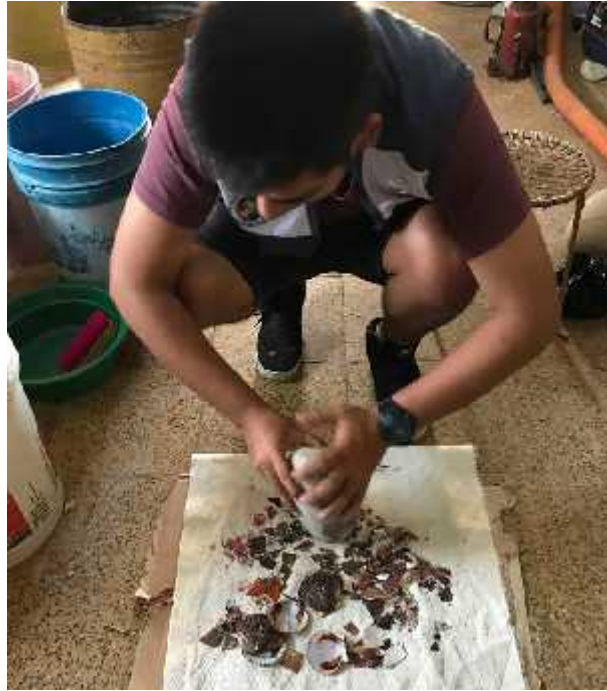
Foto N°09: Proceso de Trituración de la Concha de Abanico mediante Batan
