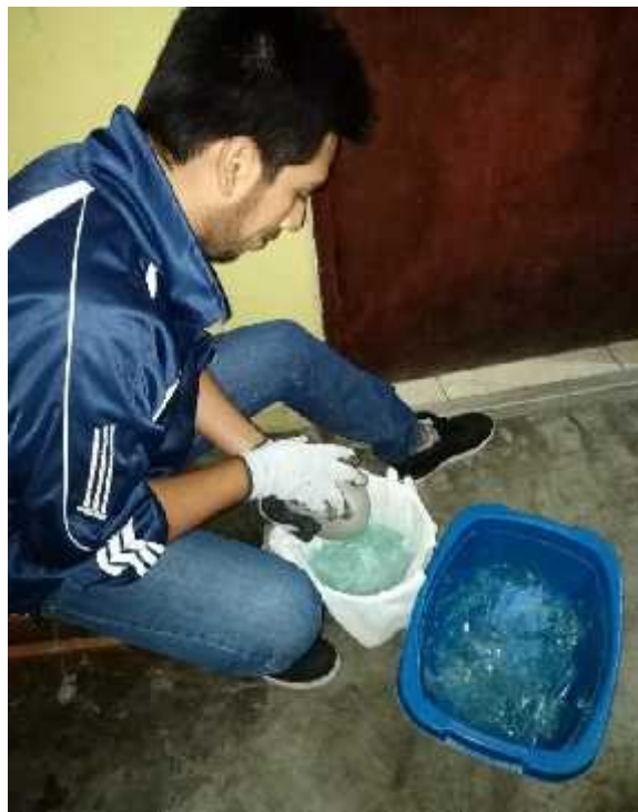
Foto N°04: Proceso de Trituración del vidrio mediante Piedra
