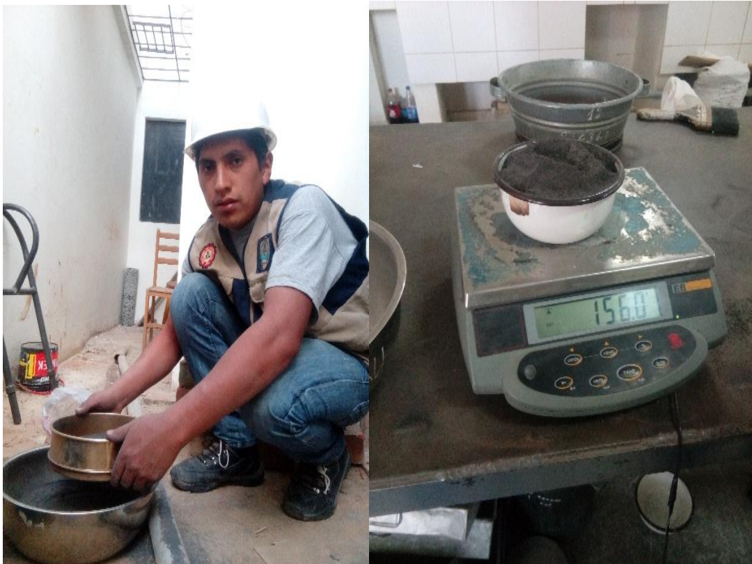
Figura 05. Tamizando Ceniza activada a 750°C
