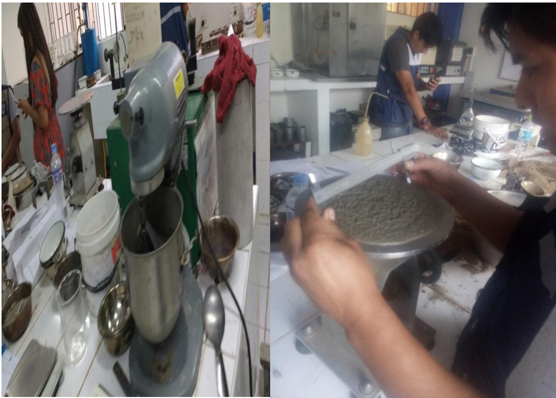
Figura 07. Ensayos Análisis de Fluidez.
