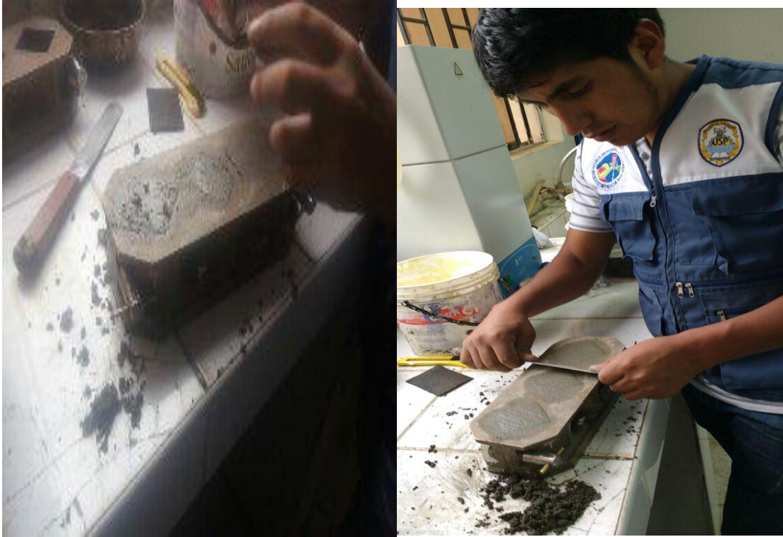
Figura 08. Preparando Cubos de Mortero para el Ensayo.
