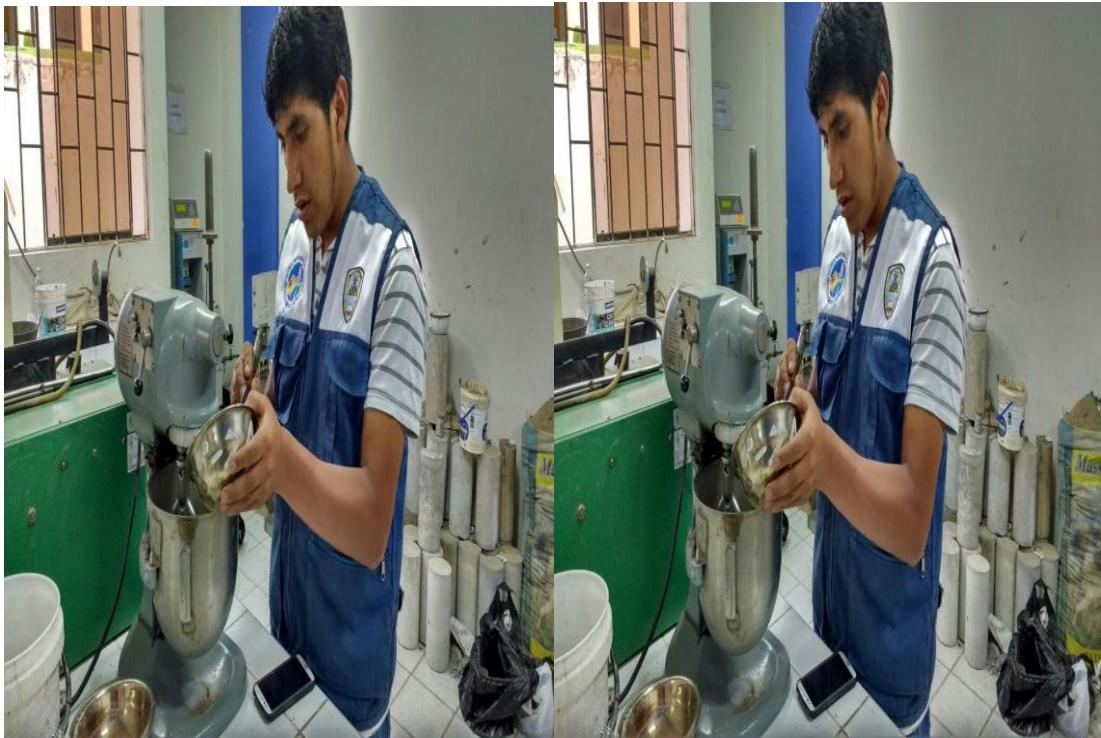
Figura 06. Preparando Mezcla Acuerdo Indica la Norma Técnica Peruana 334.003.
