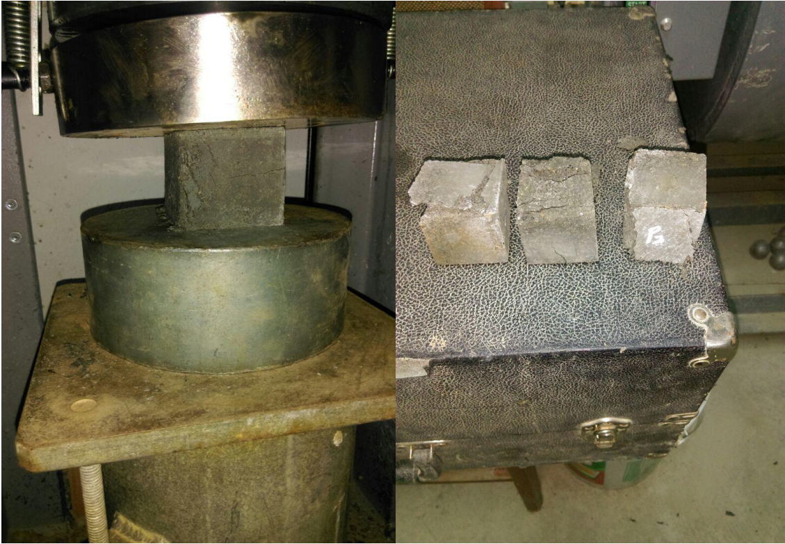
Figura 11. Dados después del ensayo fracturados
