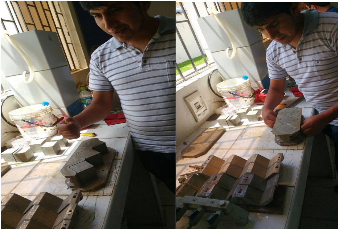
Figura 09. Desencofrado de los dados.
