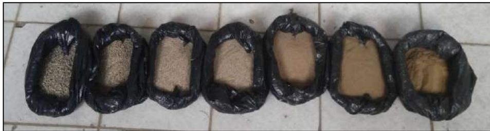
**Foto N° 5: Arena Gradada Lavada del retenido en el tamiz N° 08 al pasante del tamiz N° 200.**
