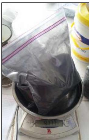
**Foto N° 15:** CCA activada térmicamente, tamizada y almacenada.
