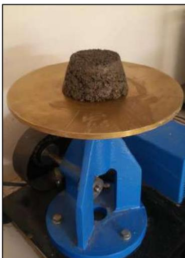
**Foto N° 18: Ensayo de Fluidez.**
