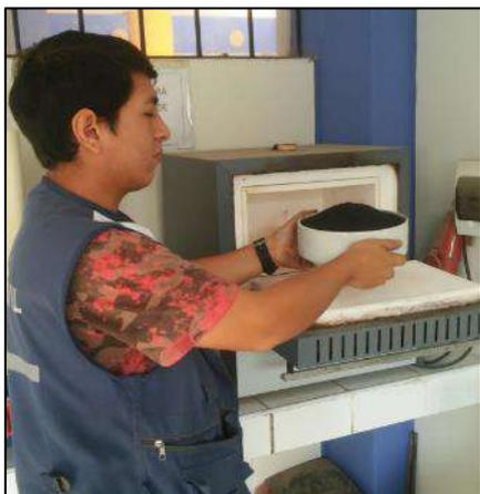
**Foto N° 14:** Activación térmica de la Ceniza de Cáscara de Arroz.
