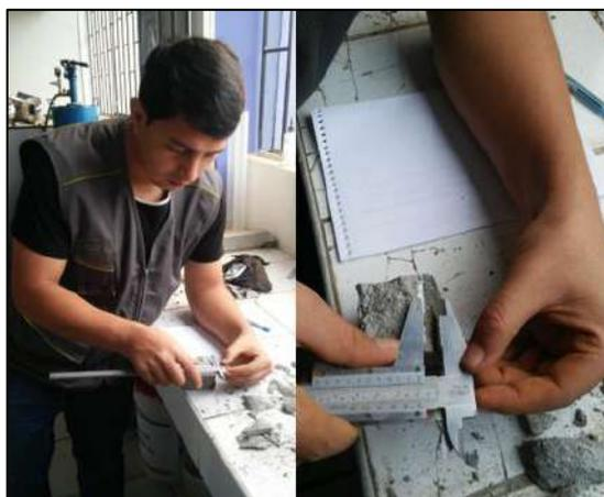
**Foto N° 28:** Medición de la penetración de agua en los cubos ensayados por permeabilidad.
