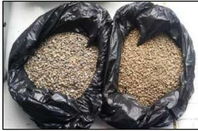
**Foto N° 4: Arena Gradada Lavada / Arena Gradada (Retenido en el tamiz N° 08).**
