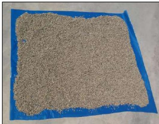
**Foto N° 3: Secado al sol de la arena retenida en el tamiz N° 08.**
