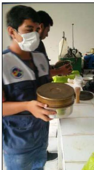
**Foto N° 10: Tamizado por la malla N° 200 del PCH activado térmicamente.**
