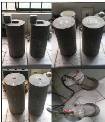
**Foto N° 26:** Fijación de cubos de mortero para ensayo de Permeabilidad.
