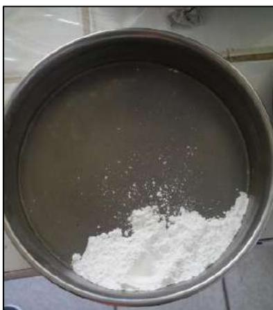
**Foto N° 11:** PCH activado térmicamente y tamizado por el tamiz N° 200.
