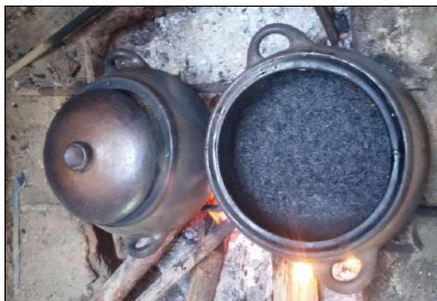
**Foto N° 12:** Calcinación de la Cáscara de Arroz en Olla de barro.
