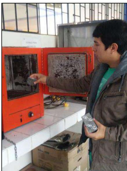
**Foto N° 24: Secado al horno de los Cubos de mortero para ensayo de Permeabilidad.**
