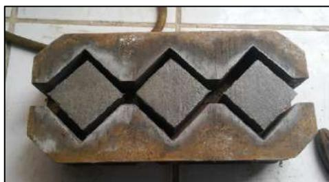
**Foto N° 20: Desencofrado de los Cubos de mortero.**
