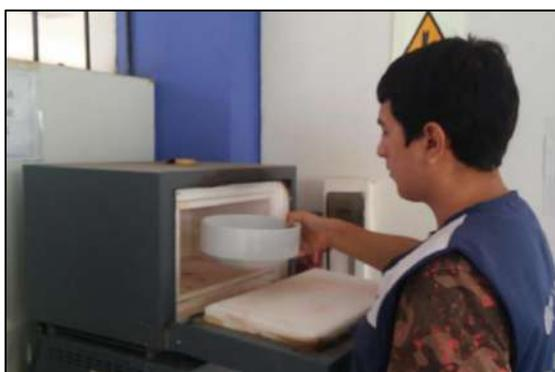
**Foto N° 9: Activación térmica del Polvo Cáscara de Huevo.**
