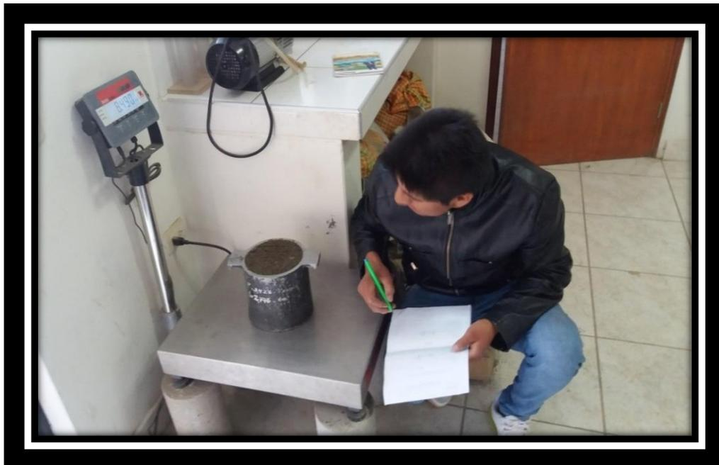
**Foto 04: Pesando el agregado fino para el ensayo de peso unitario.**
