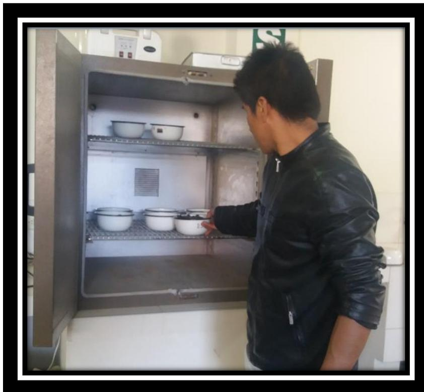
**Foto 08: Secado de los agregados en el horno a 105°C.**
