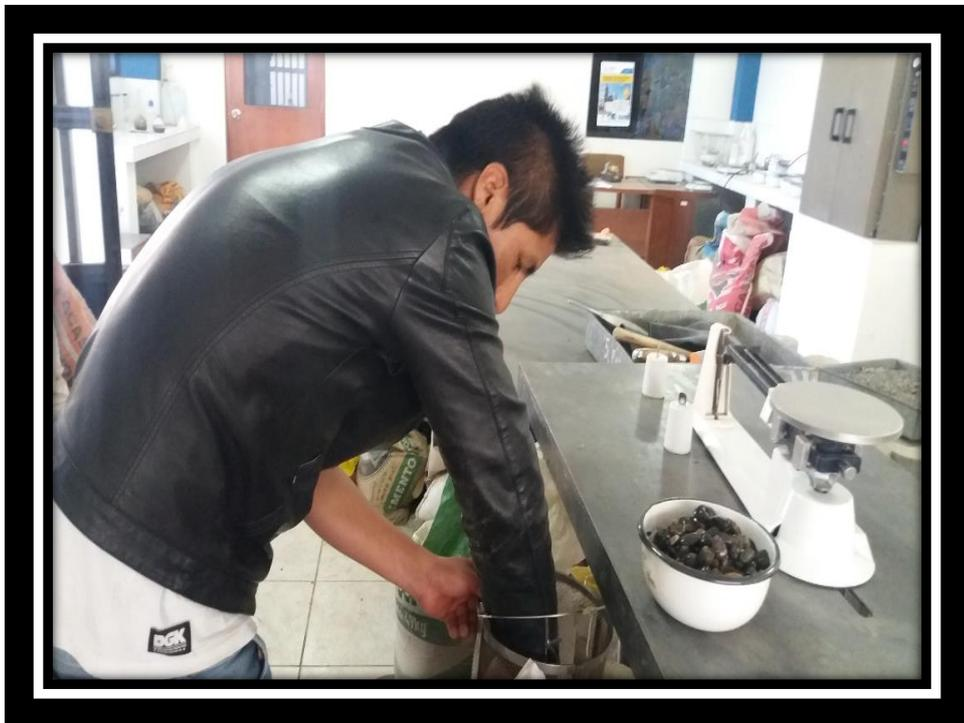
**Foto 06: Peso del agregado grueso para el contenido de humedad.**
