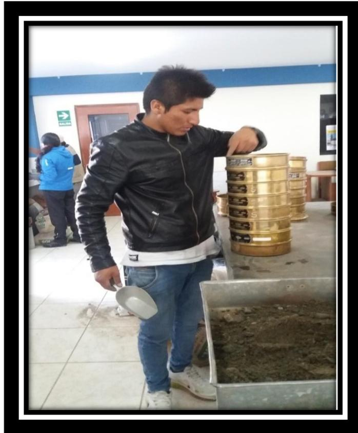
**Foto 03: Tamizado del agregado fino para la granulometría.**
