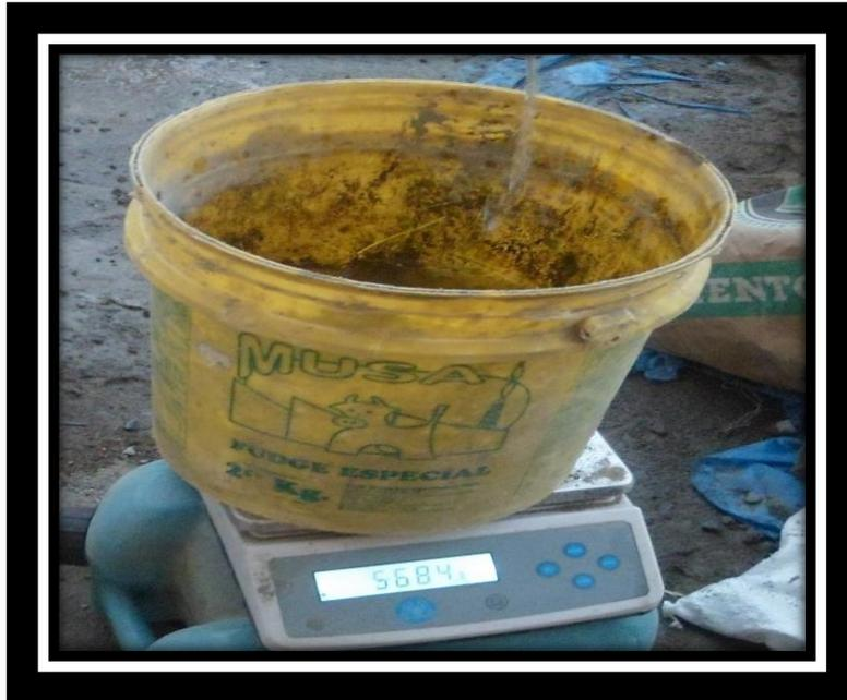
**Foto 17: Pesando el agregado grueso.**
