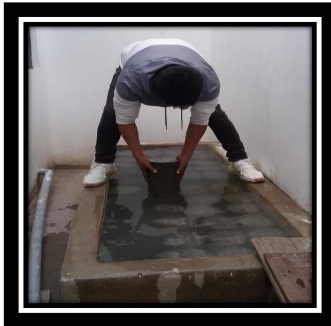
**Foto 20: Curado de las probetas.**
