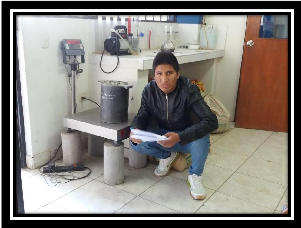
**Foto 05: Pesando el agregado grueso para el ensayo de peso unitario.**
