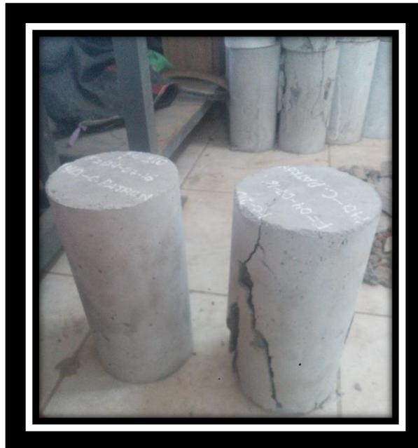
**Foto 22: Fisura de la probeta después de saber su resistencia.**
