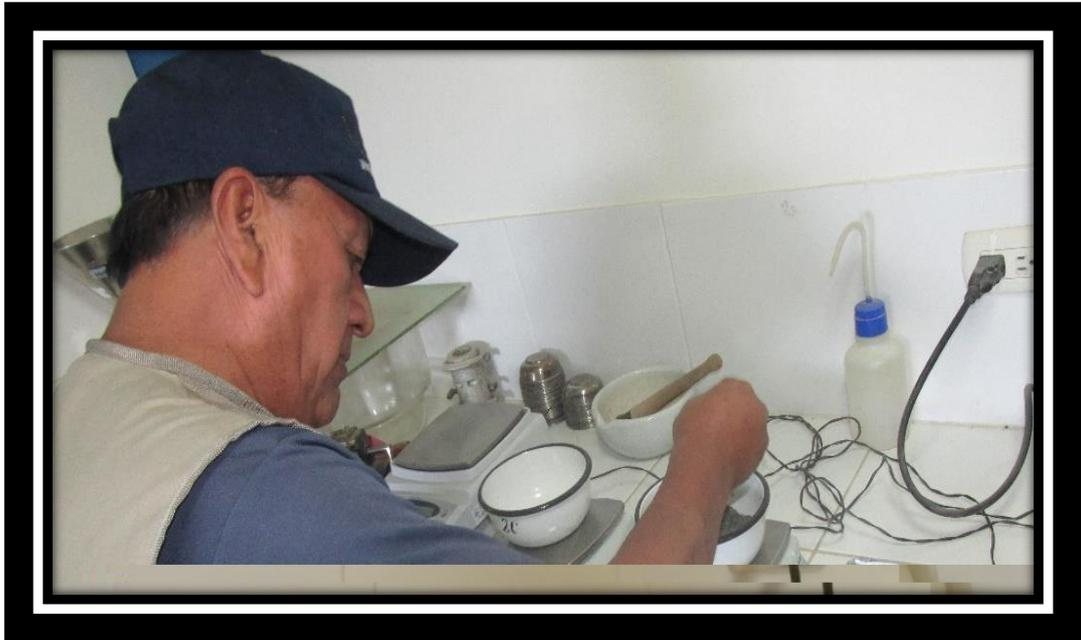
**Foto 07: Pesando el agregado fino para el ensayo de gravedad específica y absorción.**
