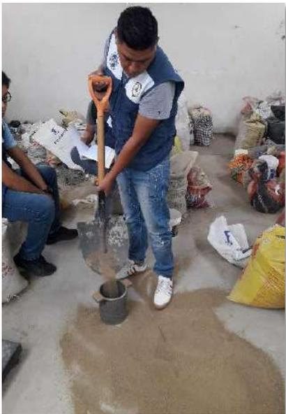
**Figura 20.** Llenando el molde para el peso unitario suelto del agregado fino
