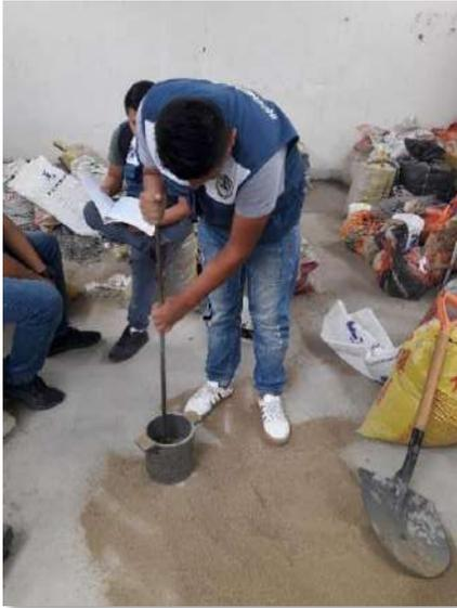
**Figura 22.** Llenando el molde para el peso unitario compactado del agregado fino.
