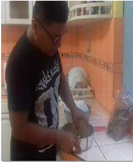
**Figura 11.** Después de calcinar la arcilla a 600°, se procede a moler, lo cual se trabajó en un batan y en un mortero
