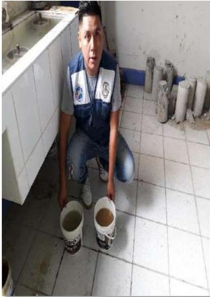
**Figura 33.** El agregado fino y grueso se colocaron en baldes con agua para el ensayo de gravedad específica.
