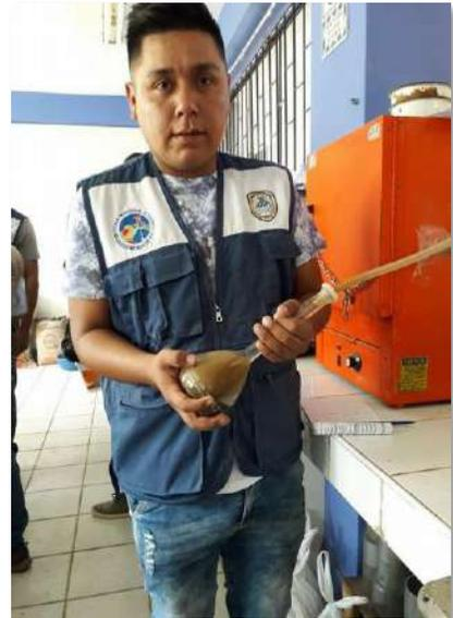
**Figura 38.** El picnómetro absorbe el aire dentro de la fiola.
