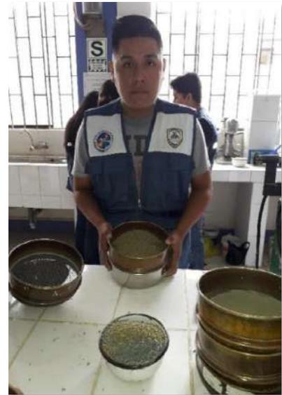
**Figura 29.** Se realizó la granulometría (tamizado pasado por las mallas establecidas)
