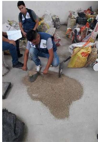
**Figura 21.** Enrasando el agregado fino suelto para el peso de la muestra
