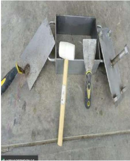
**Figura 52.** Herramientas para la elaboración del ladrillo, el molde utilizado es de acero inoxidable
