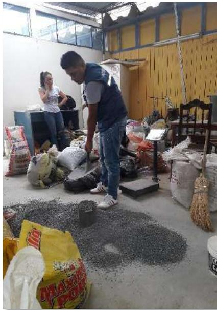
**Figura 24.** Llenando el molde para el peso unitario suelto del agregado grueso
