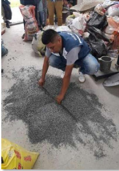
**Figura 30.** Cuarteo del agregado fino
