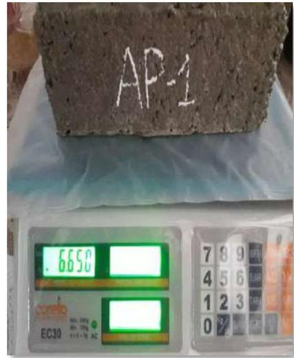
**Figura 46.** Una vez obtenidos los ladrillos pesamos antes del curado y también después del curado
