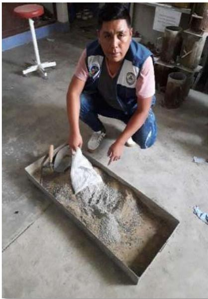
**Figura 39.** Se hace la mezcla manualmente dando de 5 vueltas a la mezcla
