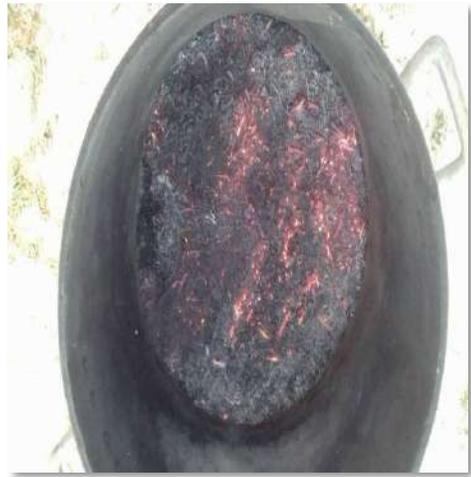
**Figura 18.** Se dejó enfriar para poder tamizar por la malla n° 200 y poner a calcinar
