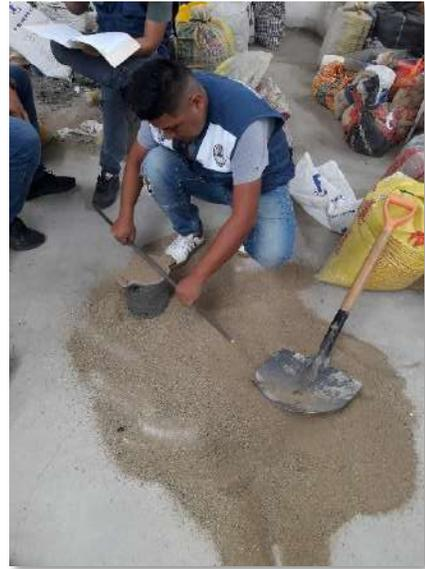
**Figura 23.** Enrasando el agregado fino compactado para el peso de la muestra.
