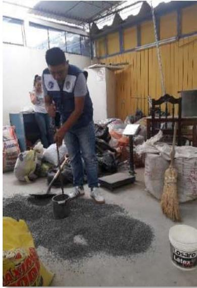
**Figura 26.** Llenando el molde para el peso unitario compactado del agregado grueso
