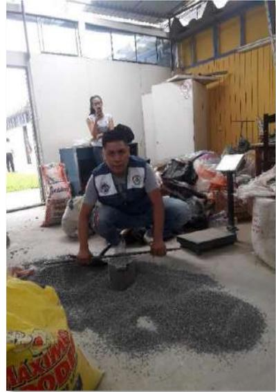
**Figura 27.** Enrasando el agregado grueso compactado para el peso de la muestra
