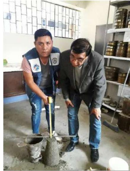
**Figura 42.** Con la supervisión de mi asesor el Ing. Rigoberto Cerna se procedió a medir el asentamiento del diseño, cumpliendo con lo establecido de 0 a 2''
