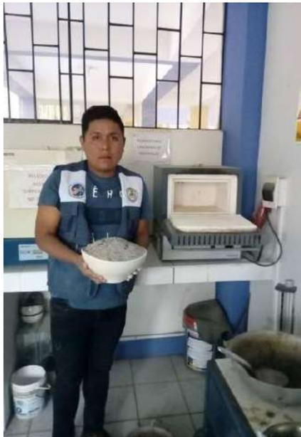
**Figura 19.** Para realizar este ensayo se tamiza la ceniza de la hoja de molle obtenida en el pre-quemado, luego se la ceniza para ser introducido a la mufla y ser expuesta a 900° C durante 4 horas.
