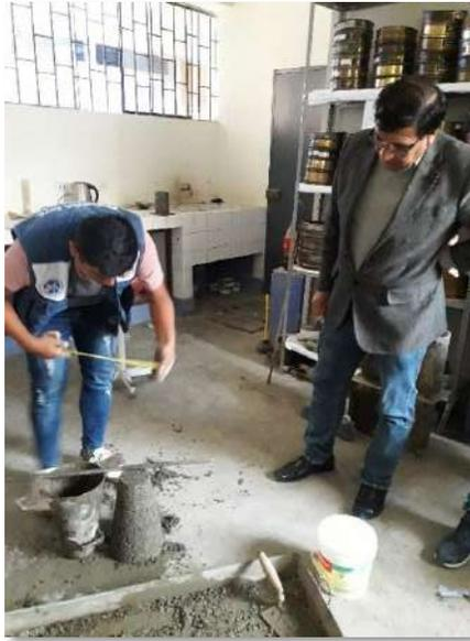
**Figura 41.** Se retira el cono abrams para ver el asentamiento de la mezcla
