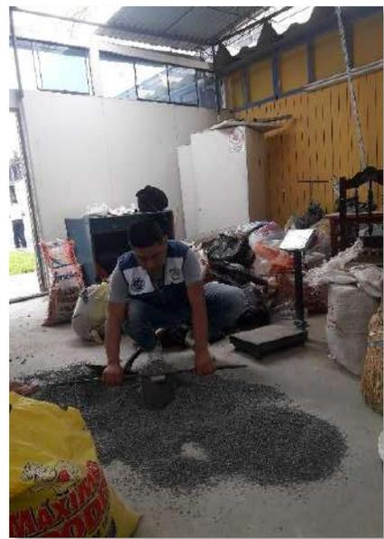
**Figura 25.** Enrasando el agregado grueso suelto para el peso de la muestra
