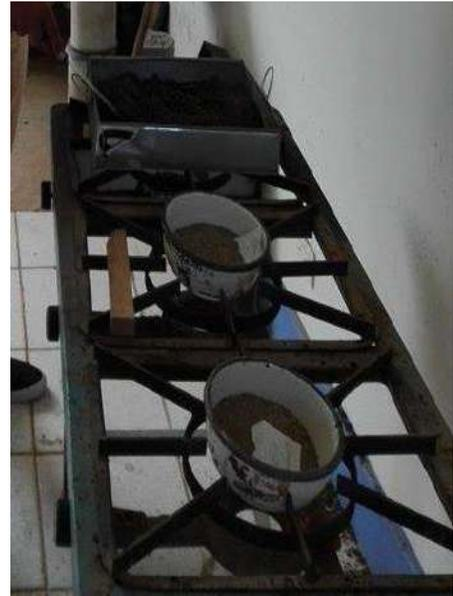
**Figura 34.** El secado del agregado fino se realizó en la cocina para luego pasar al picnómetro.
