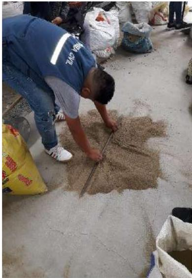
**Figura 28.** Cuarteo del agregado fino
