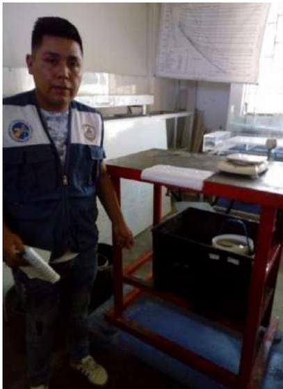
**Figura 35.** El agregado grueso es sumergido para el peso específico.
