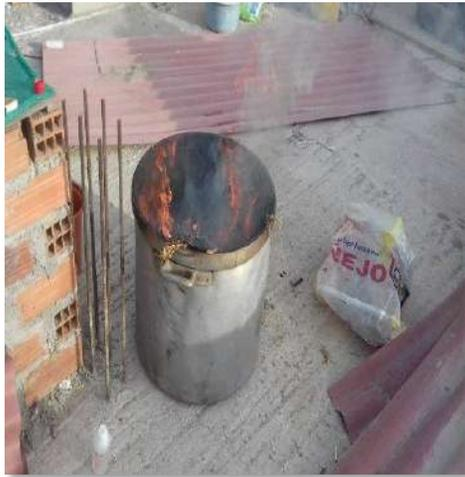
**Figura 17.** Una vez seco las hojas de schinus (molles) se hace un pre quemado al aire libre, se utilizó un olla y una botella de alcohol medicinal de 250 ml,
