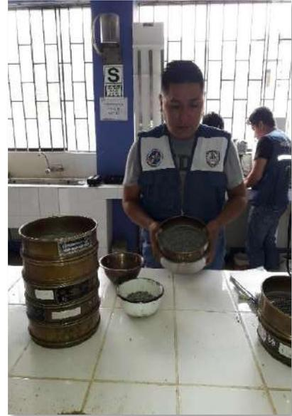
**Figura 31.** Se realizó la granulometría (tamizado pasado por las mallas establecidas)
