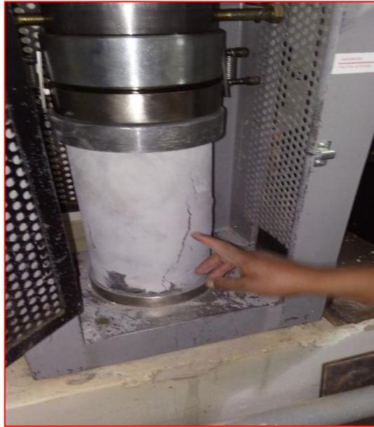
**Fotografía N<sup>o</sup> 09:** La probeta ha sufrido una fisura de tipo corte como se puede observar en la imagen.
