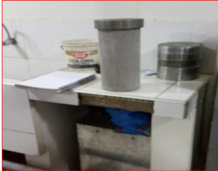
**Fotografía N<sup>a</sup> 07:** Colocación del plato Cilíndrica sobre la probeta para ser puesto en la prensa para obtener su resistencia a la compresión.
