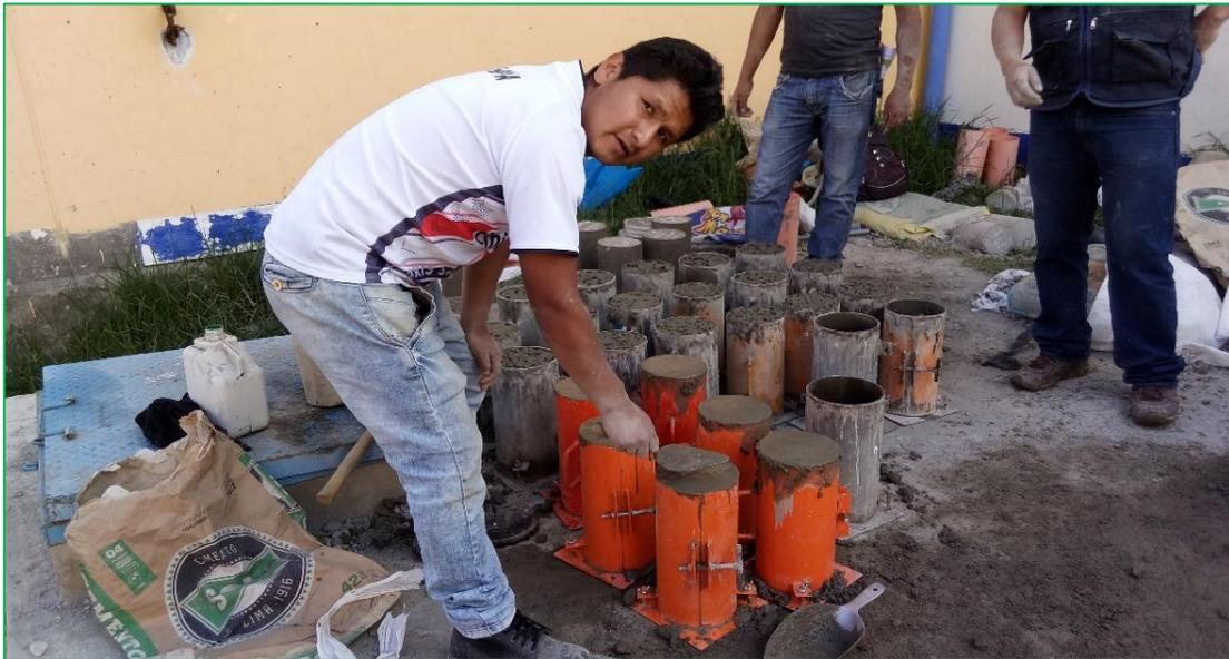
**Fotografía Nª 06:** El vaciado de la mezcla en los moldes cilíndricos, con sustitución 0%, 2%, 4% y 6% de escoria de soldadura de electrodo por cemento.
