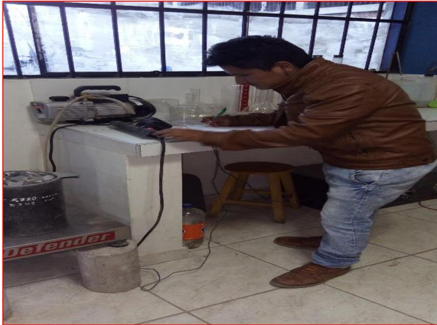
**Fotografía Nª 05:** Realización del peso unitario del agregado grueso.
