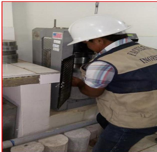
**Fotografía N<sup>a</sup> 08:** La probeta ya lista en la prensa, esta recibe una carga axial para obtener su resistencia.
