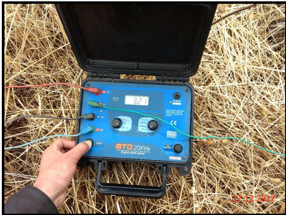
FIGURA N° 08. Resultado de prueba de resistividad en la localidad El Molle, a distancia 6m
