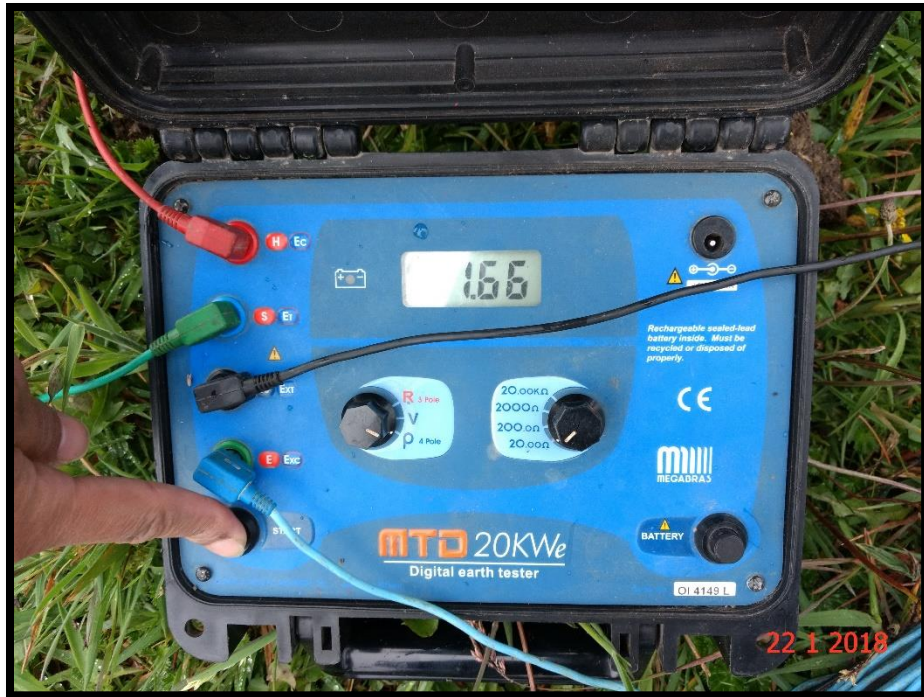
FIGURA N° 01. Resultado de prueba de resistividad en la localidad Ingacorral Sector Monteron a 6m
