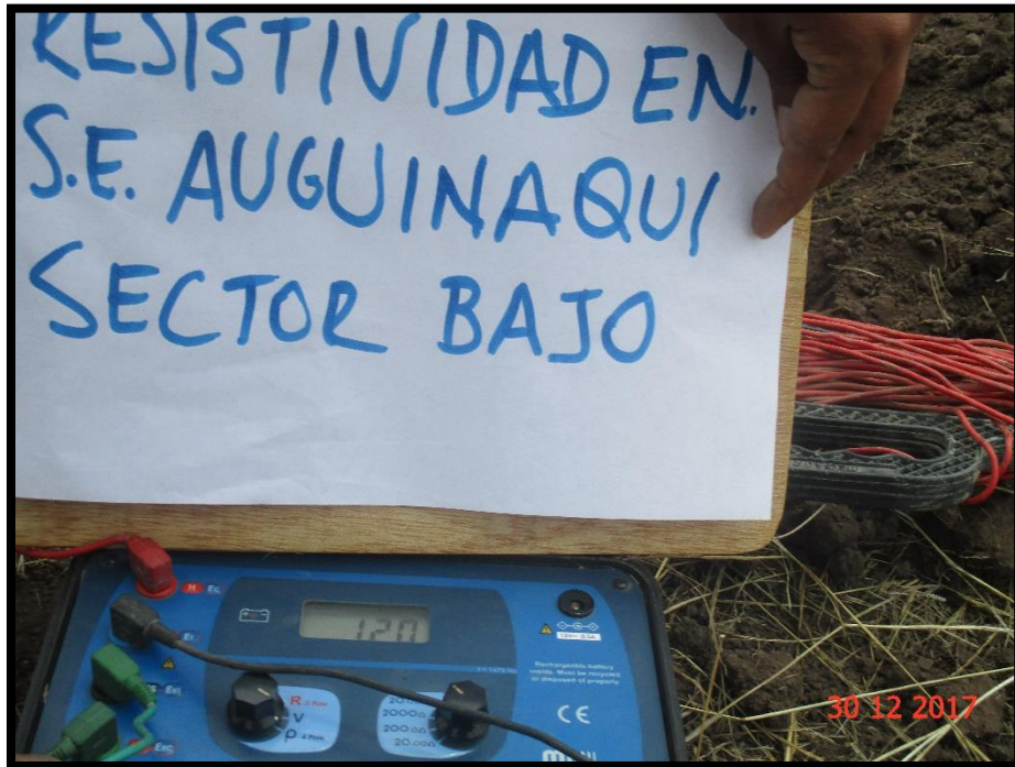
FIGURA N° 05. Resultado de prueba de resistividad en la localidad Auguinaqui Sector Bajo, a distancia de 2m
