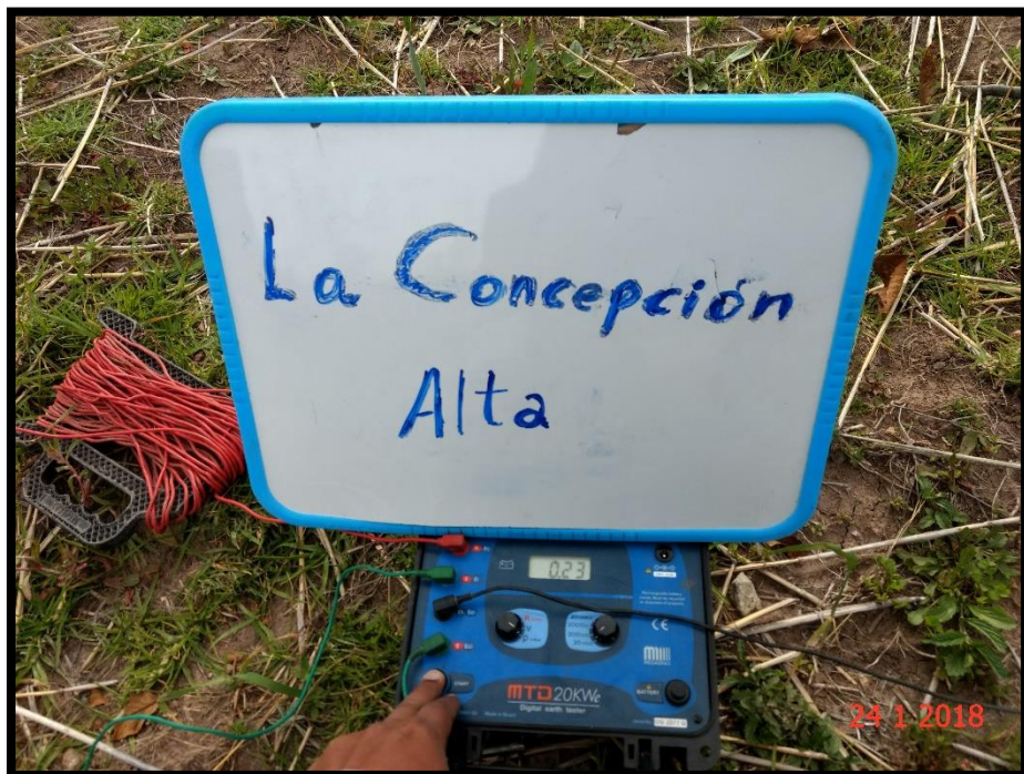
FIGURA N° 02. Resultado de prueba de resistividad en la localidad La Concepción Alta a 6m
