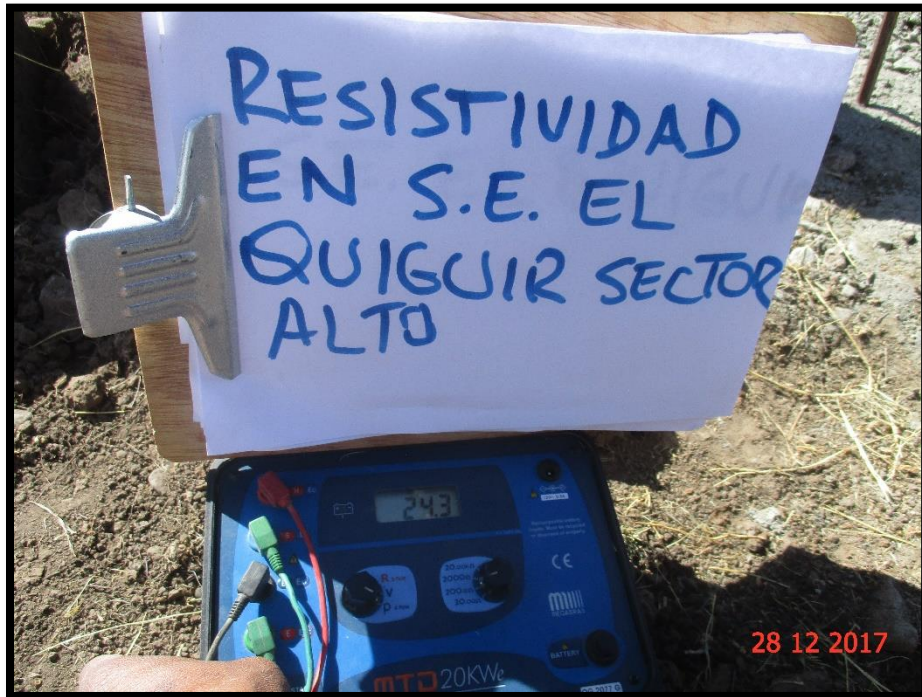
FIGURA N° 09. Resultado de prueba de resistividad en la localidad el Quiguir Sector Alto, a distancia de 8m
