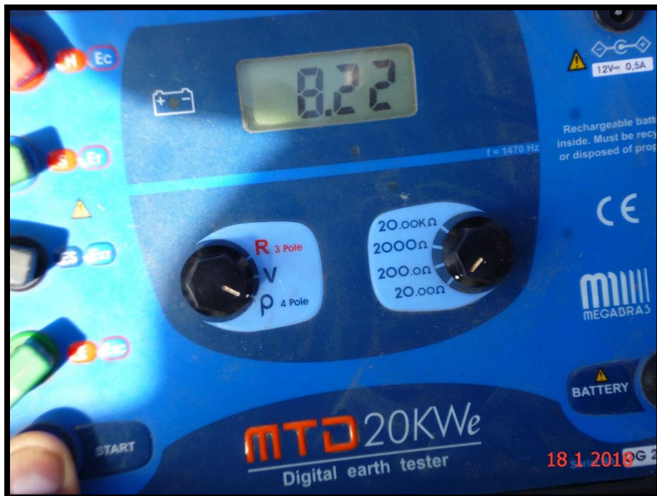
FIGURA N° 20. Resultado de prueba de resistividad en la localidad Ururupa Alta, a distancia 4m
