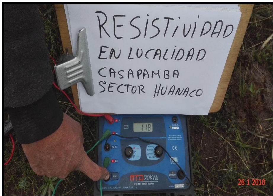
FIGURA N° 06. Resultado de prueba de resistividad en la localidad Casapamba Sector Huanaco, a distancia 4m
