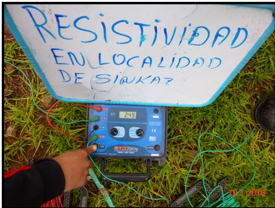
FIGURA N° 16. Resultado de prueba de resistividad en la localidad Sincas, a una distancia de 4m
