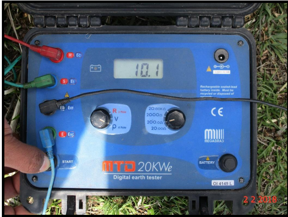
FIGURA N° 07. Resultado de prueba de resistividad en la localidad Chulite Alto, a distancia 4m
