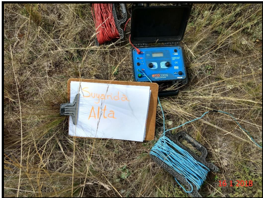
FIGURA N° 18. Preparación de telurometro para iniciar prueba de resistividad en la localidad Suyarida Alta
