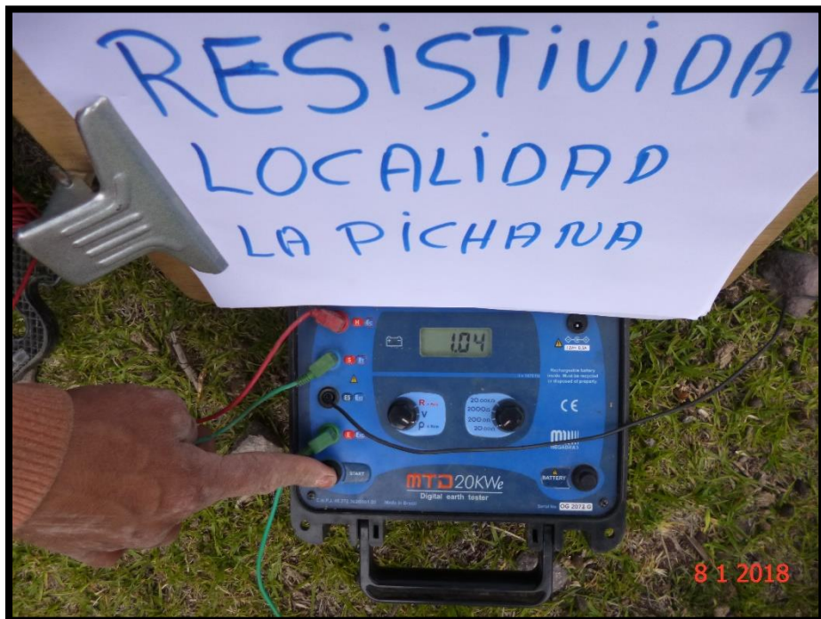
FIGURA N° 14. Resultado de prueba de resistividad en la localidad de Pichana, a una distancia de 8m
