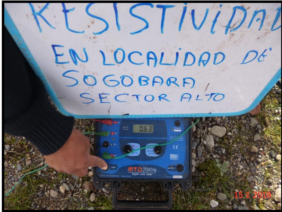
FIGURA N° 17. Resultado de prueba de resistividad en la localidad Sogobara Sector Alto, a distancia de 6m
