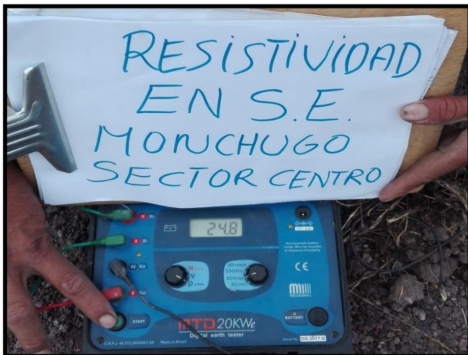
FIGURA N° 12. Resultado de prueba de resistividad en la localidad Monchugo Sector Centro, a distancia de 4m
