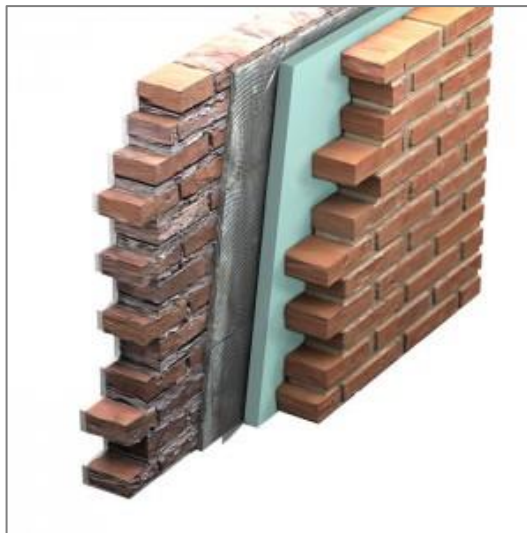
Imagen 11: Doble muro con cámara de aire
