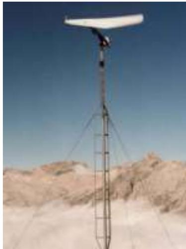
Figura N°06. Aerogenerador por número de Palas - De Una Pala
